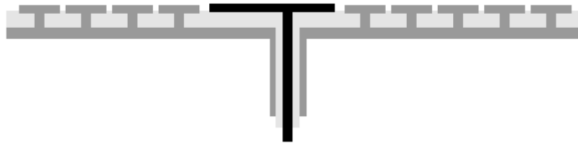
Figura 9: Vista da secção transversal de uma antena planar envolta por uma Superfície de Alta Impedância no mesmo nível.
