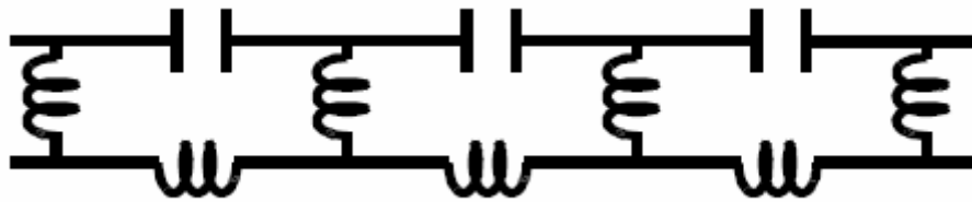
Figura 4: Circuito equivalente de uma Superfície de Alta Impedância.
