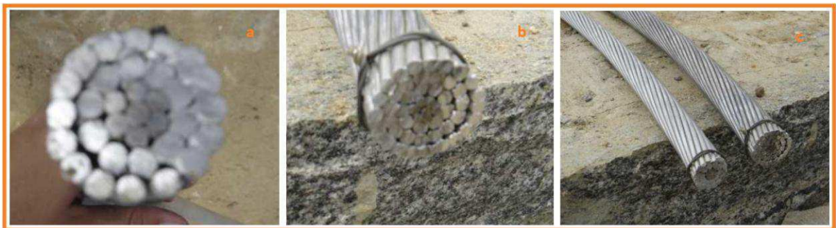
Figura 14 – Condutores Utilizados: (a) 636 MCM – grosbeak (b) 954 MCM – rail (c) comparativo entre ambos
