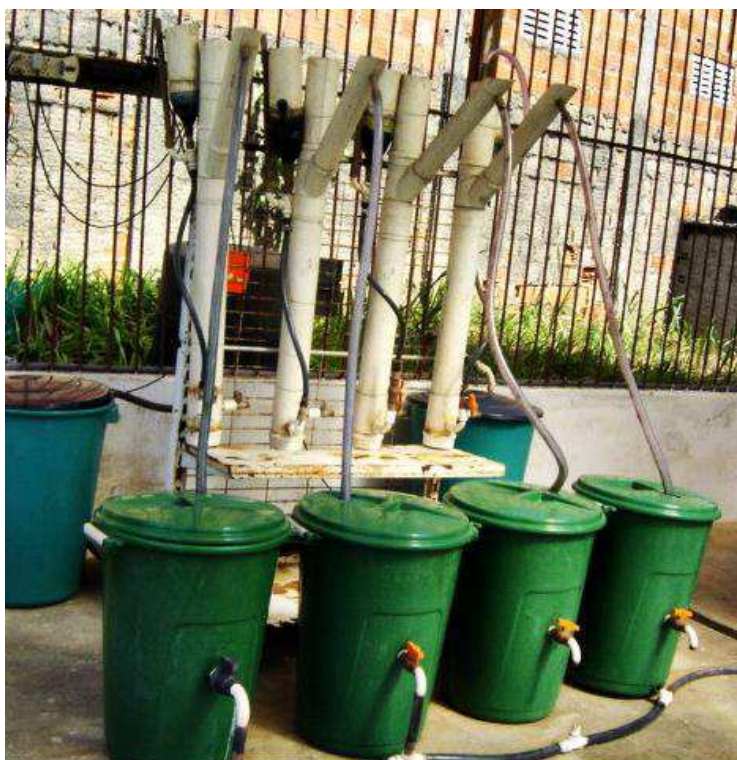
Figura 1. Reator UASB na estação de tratamento EXTRABES. Campina Grande, PB, 2016.
