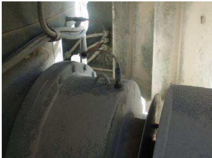
Figura 3.5 - Sensores de temperatura do moinho de cru.
