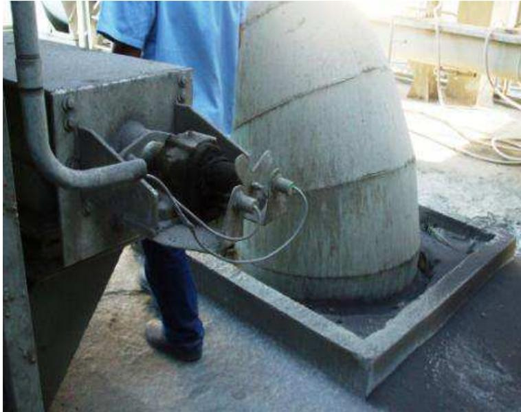
Figura 3.2- Sensor indutivo supervisionando a rotação de uma rosca transportadora.
