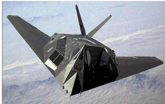
Figura 2.2 - F-117 Nighthawk (US Airforce), o primeiro avião do mundo a utilizar tecnologia Stealth, possuindo estruturas FSS na sua carcaça.
