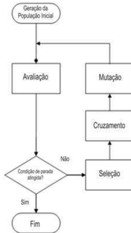
Figura 3.2 - Esquema do funcionamento de um algoritmo genético simples
