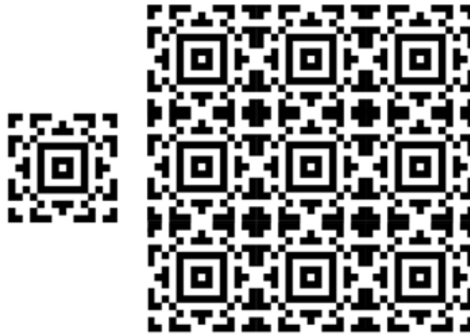
Figura 6.5 - Célula elementar e estrutura FSS correspondente para um filtro rejeita-faixa GSM (900MHz) pouco sensível ao ângulo de incidência \theta .
