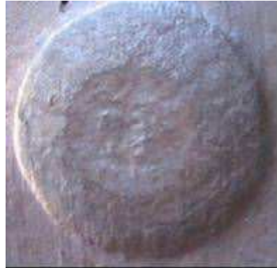
Figura 23. Formato esférico de uma solda intercell.
