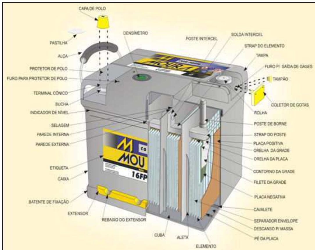
Figura 25. Visão geral dos componentes de uma bateria automotiva.
