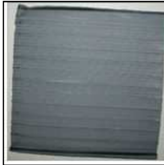
Figura 20. Separador de polietileno de uma bateria automotiva.
