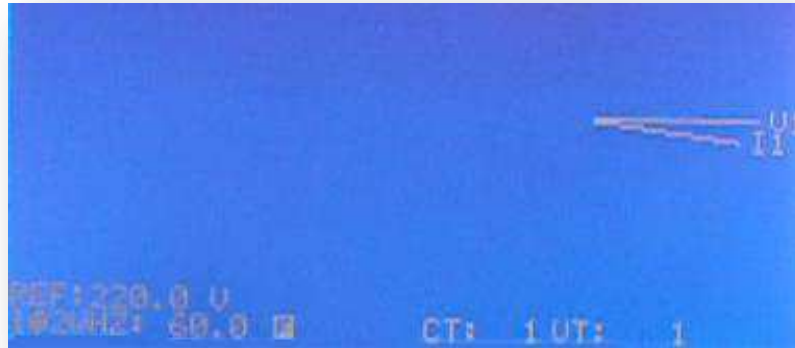
Figura 19 – Diagrama fasorial da tensão de fase e corrente de linha exibido pelo analisador LASSE – 1.
