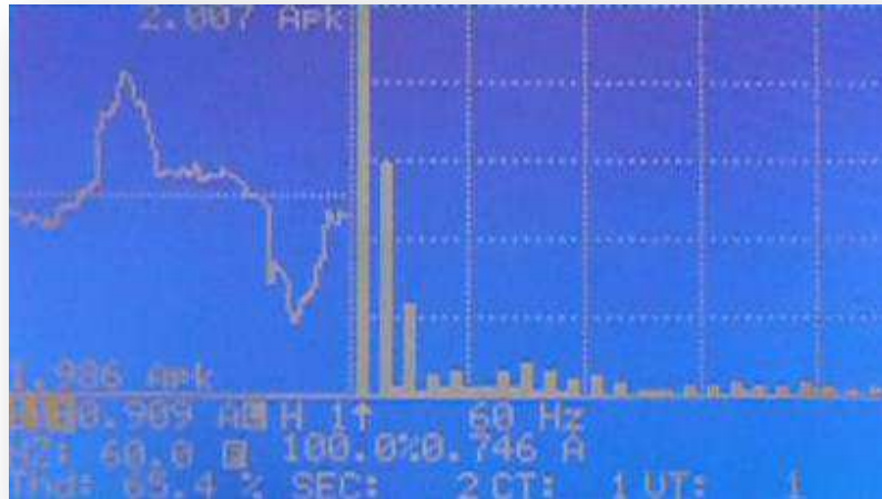
Figura 16 – Tela dos dados de Harmônica de corrente de linha exibidos pelo analisador LASSE – 1.
