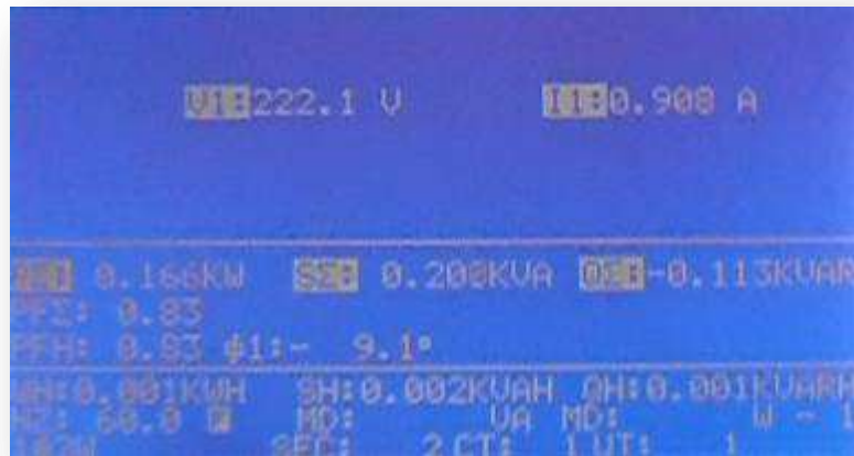
Figura 11 – Tela dos dados de Potência exibidos pelo analisador LASSE – 1.
