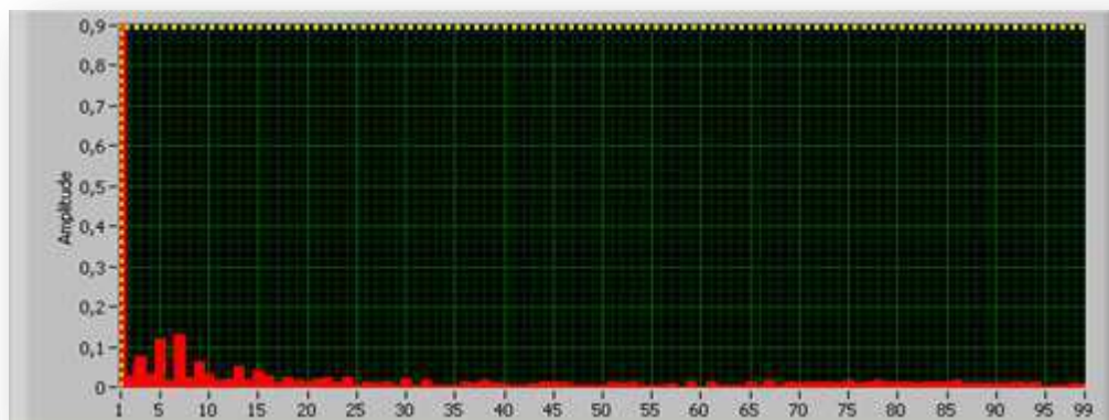
Figura 38 – Espectro de frequência da corrente elétrica que percorre a lâmpada incandescente.
