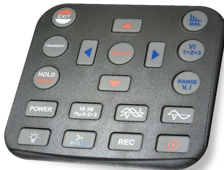
Figura 9 – Menu de botões do analisador LASSE - 1.
