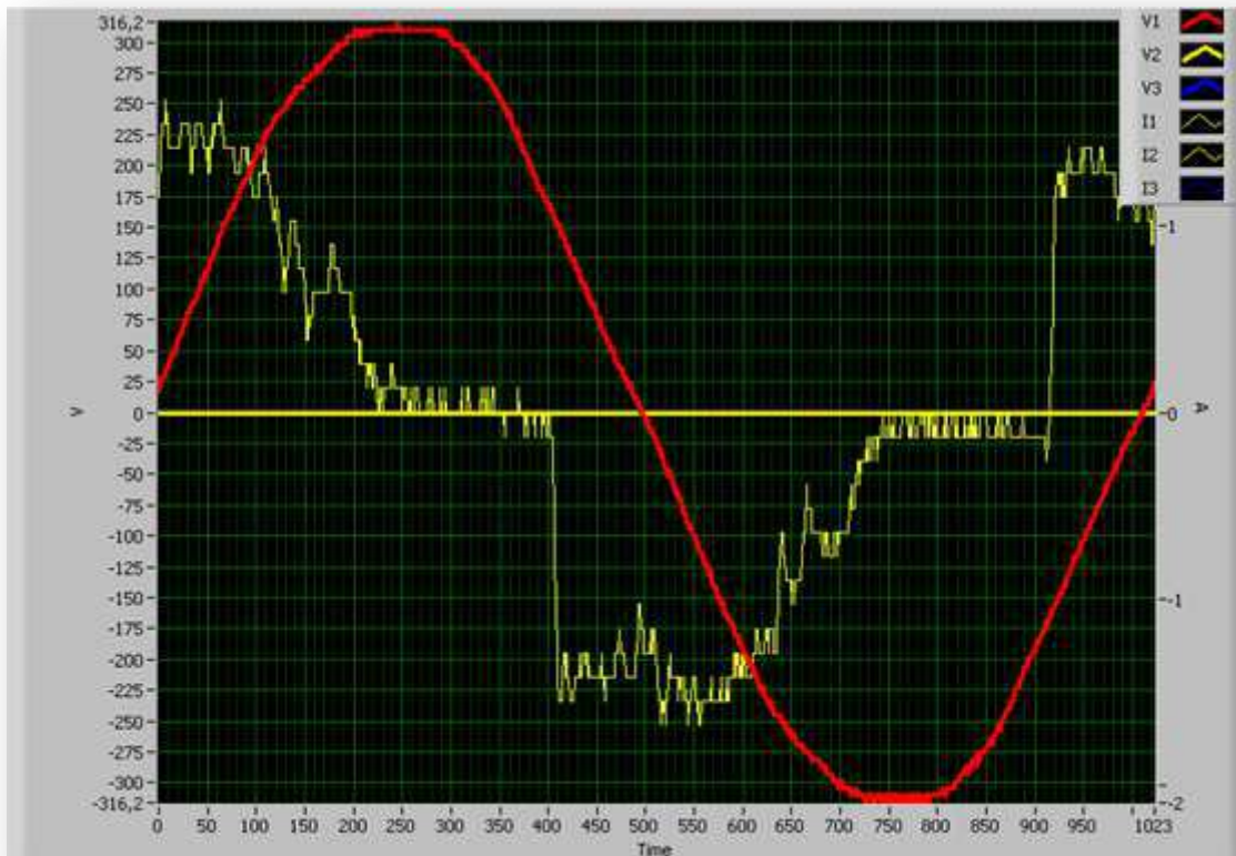
Figura 33 – Formas de onda da tensão de alimentação e da corrente elétrica para a lâmpada LED.
