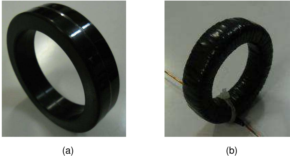
Figura 46 – (a) Núcleo toroidal de liga nanocristalina. (b) Núcleo toroidal de liga nanocristalina com 300 espiras no secundário.
