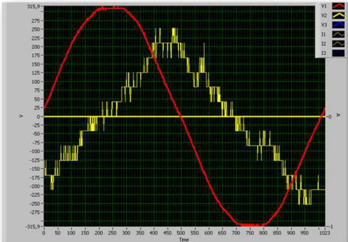
Figura 35 – Formas de onda da tensão de alimentação e da corrente elétrica para a lâmpada fluorescente tubular.
