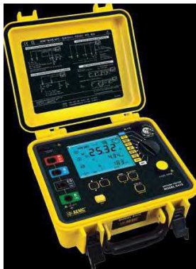
Figura 32. Terrômetro Digital utilizado na medição da resistividade do solo (ANDRADE Jr, 2011).
