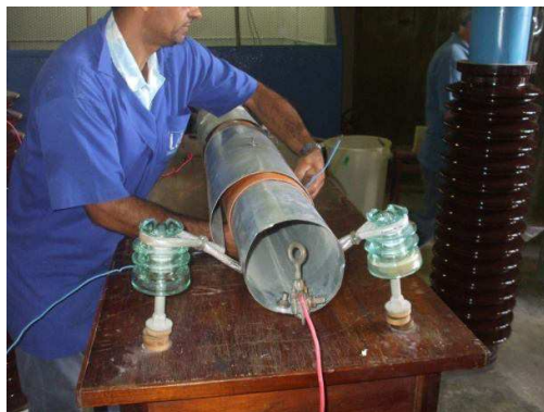
Figura 20. Ensaio em cobertura tipo circular.
