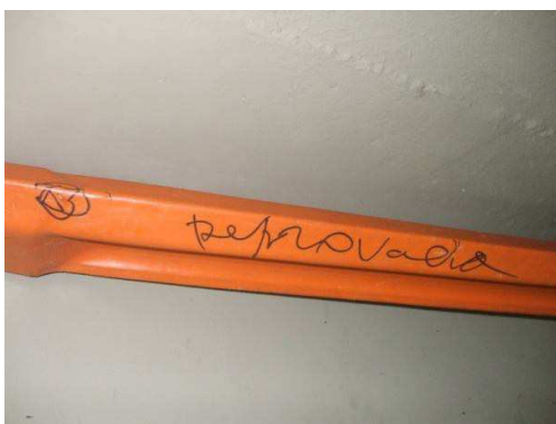
Figura 18. Cobertura tipo rígida que foi reprovada durante ensaio.
