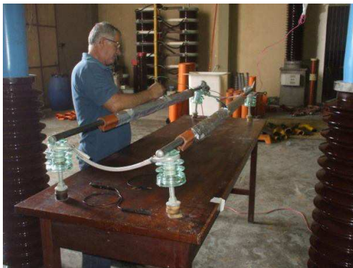
Figura 19. Ensaio em cobertura tipo flexível.
