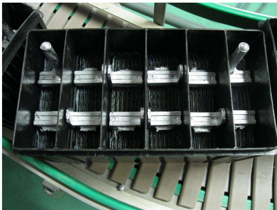
Figura 08: Montagem de uma bateria
