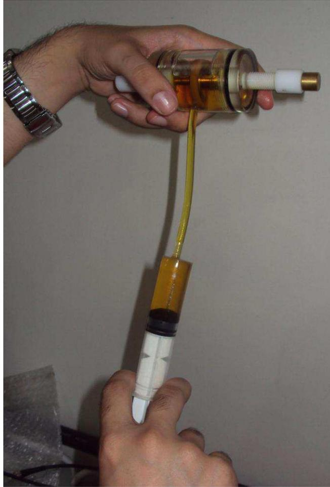
Figura 5. Fotografia de inserção de óleo na Célula de Teste.
