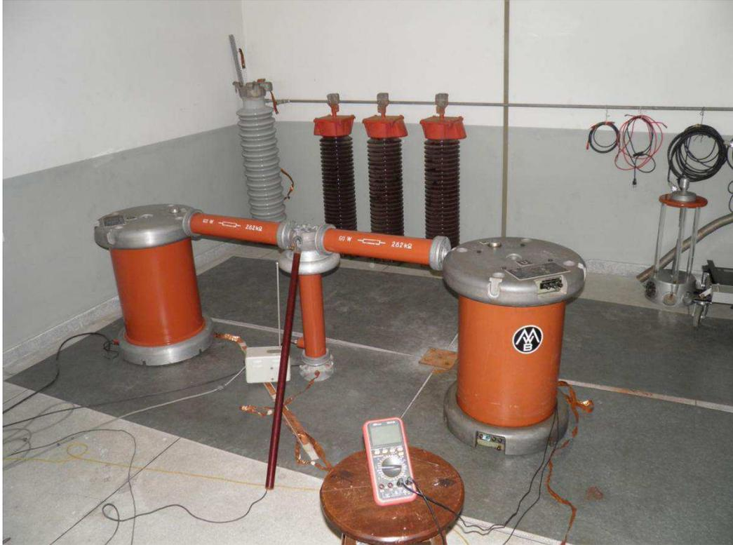
Figura 24. Fotografia do circuito para medição de relação de tensão do transformador.
