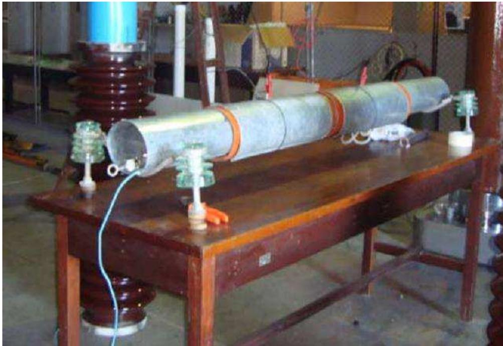
Figura 15. Fotografia de ensaio de cobertura protetora circular para postes.
