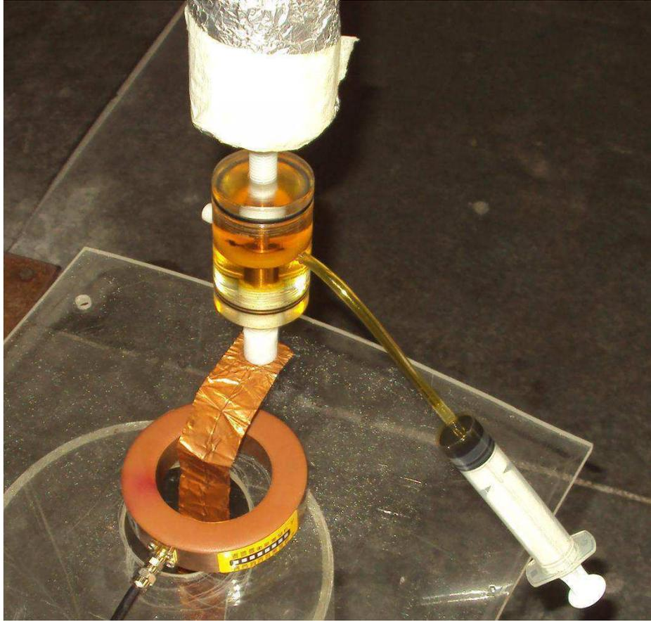
Figura 8. Detalhe do transformador de corrente usado para amplificação da corrente de fuga do objeto de teste.
