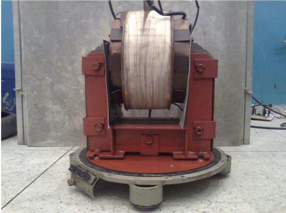
Figura 21. Fotografia da parte ativa do transformador.
