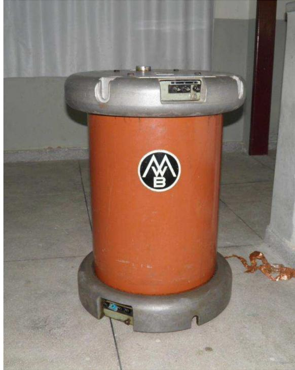
Figura 20. Fotografia do transformador do LAT para ensaios em Alta Tensão.
