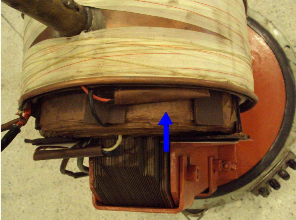
Figura 23. Detalhe da localização do defeito no transformador.
