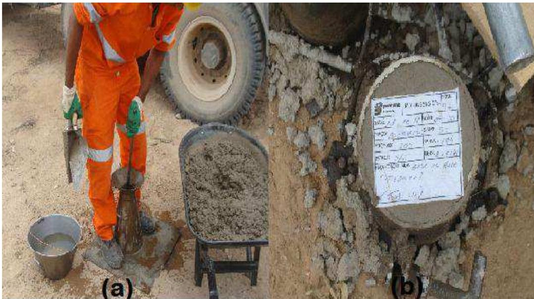
Figura 3.15 - (a)Fotografia do *Slump Test*. (b)Fotografia do corpo de prova.
