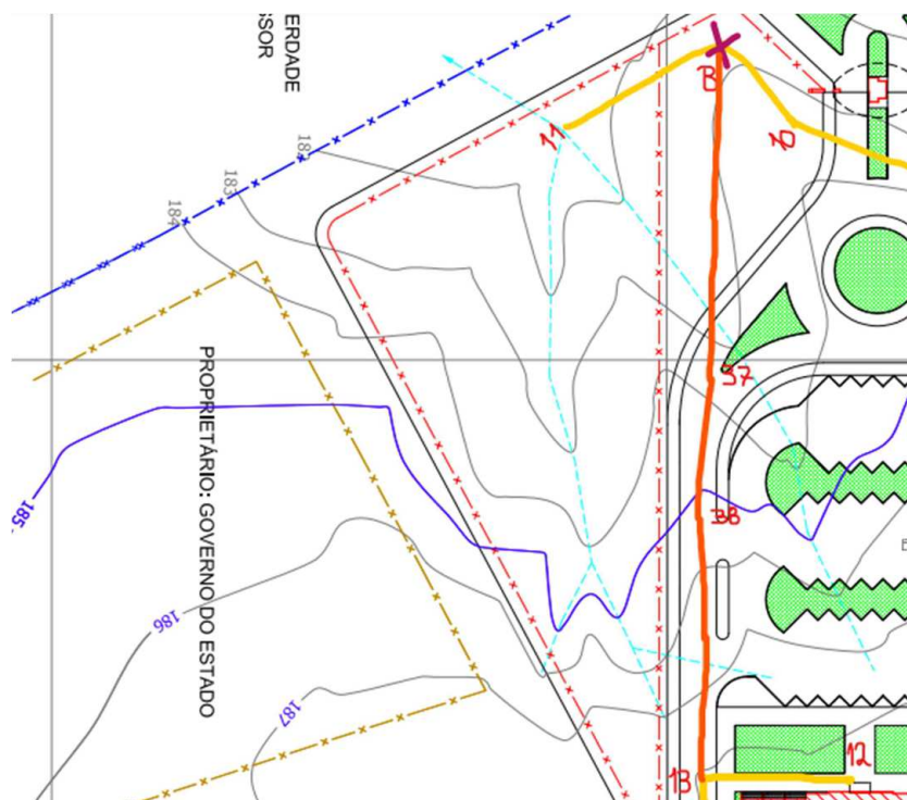
Figura 13: Trecho sem escoamento por gravidade. Fonte: O autor (2021)
