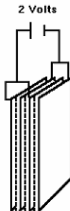
Figura 10 – Células associadas em paralelo. Elemento.
