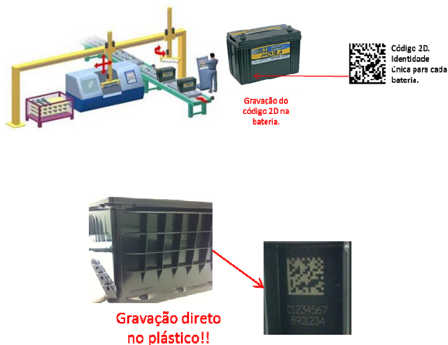
Figura 25 – Gravação do código 2D no conjunto plástico da bateria.
