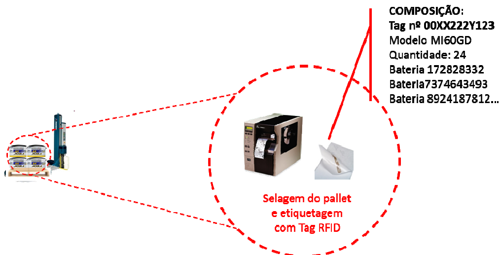
Figura 28 – Impressão da etiqueta RFID que identificará o pallet.
