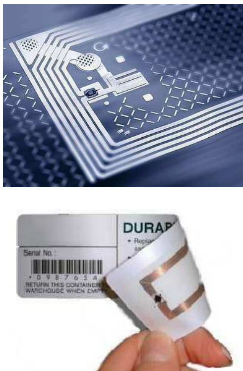
Figura 16 – Visão ampliada de um chip RFID e um exemplo de etiqueta. ( www.discoverrfid.org )
