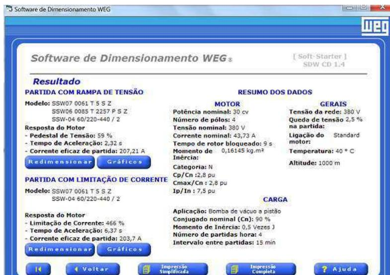
Figura 3.14- Dimensionamento da Soft-Starter para o sistema de Resfriado
