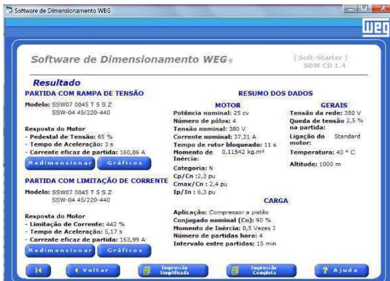
Figura 3.15- Dimensionamento da Soft- Starter para o sistema de Congelado
