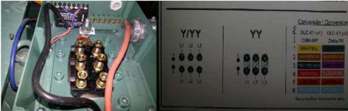
Figura 3.20- Fechamento elétrico dos bonés do compressor
