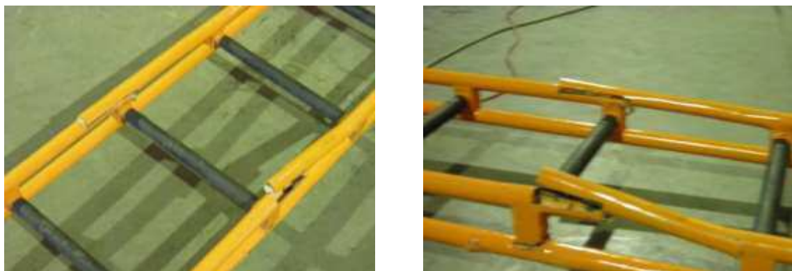
Figura 10 - Escada reprovada em ensaio de tração.
