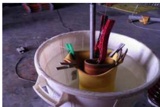
Figura 14 - Esquema e montagem invertida para ensaio de mangas isolantes.
