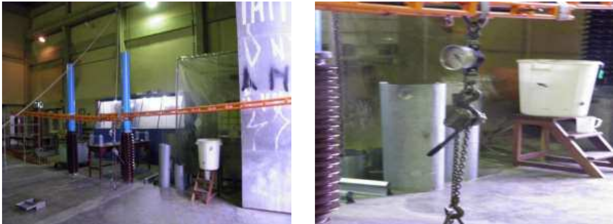
Figura 9 - Arranjo para ensaio de tração em escadas.
