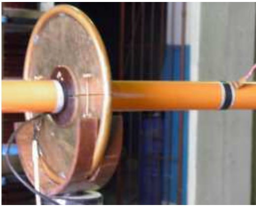
Figura 7 - Ensaio em bastão de manobra.
