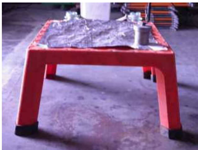
Figura 11 - Ensaio em banqueta isolante.
