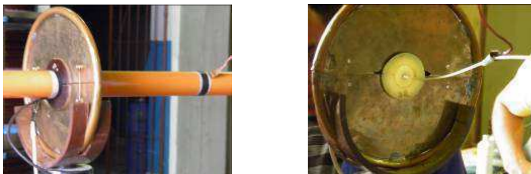
Figura 25 - Arranjo de ensaio de Bastão e linha de mão isolante a 30 cm
