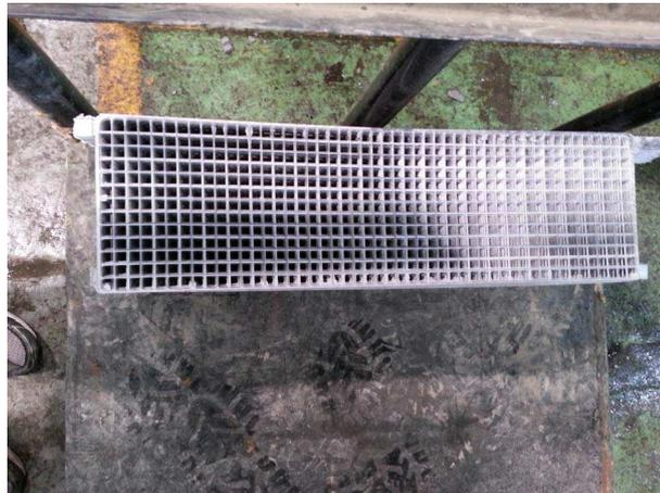
Figura 3.4: Grade negativa após a fundição
