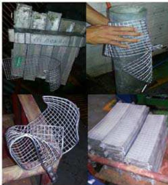
Figura 4.14: Testes de trinca e de flexibilidade
