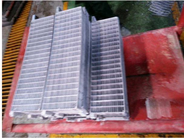
Figura 3.3: Grade positiva após a fundição
