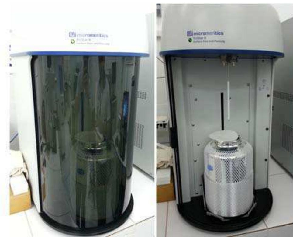
Figura 4.9: Analizador de Superfície
