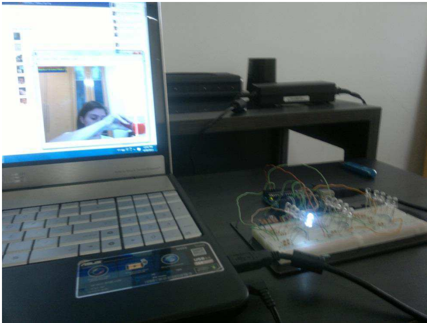
FIGURA 14A - FUNCIONAMENTO DO CÓDIGO DO APÊNDICE E (DETECÇÃO DO OBJETO VERMELHO NO CANTO INFERIOR DA TELA)
