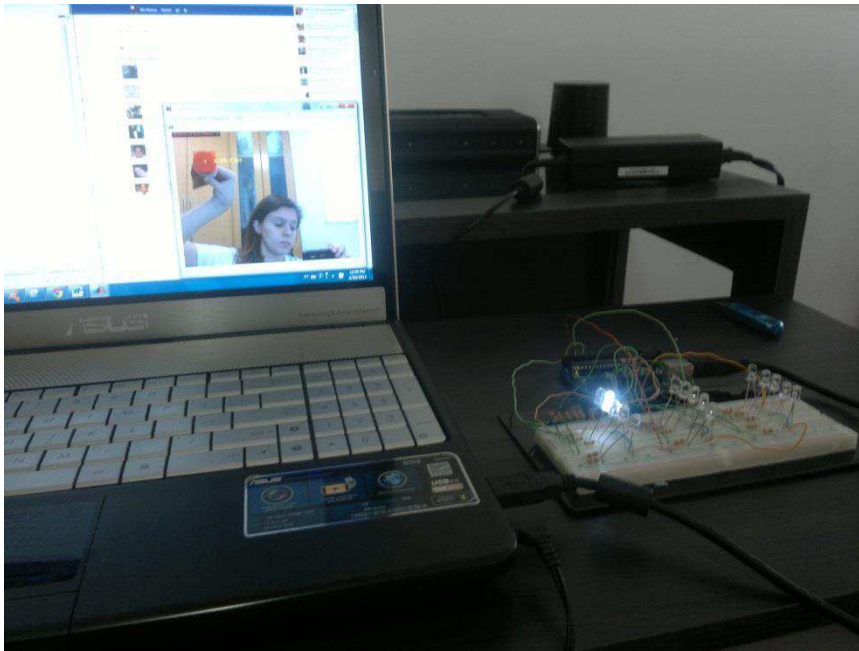
FIGURA 13A – FUNCIONAMENTO DO CÓDIGO DO APÊNDICE D (DETECÇÃO DO OBJETO VERMELHO NO CANTO SUPERIOR ESQUERDO DA TELA)
