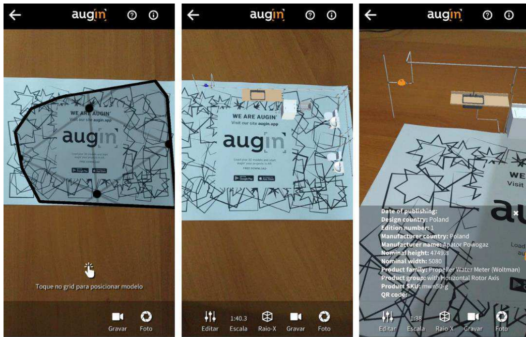
Figura 55: Visualização por alvo-padrão e verificação de informações BIM
