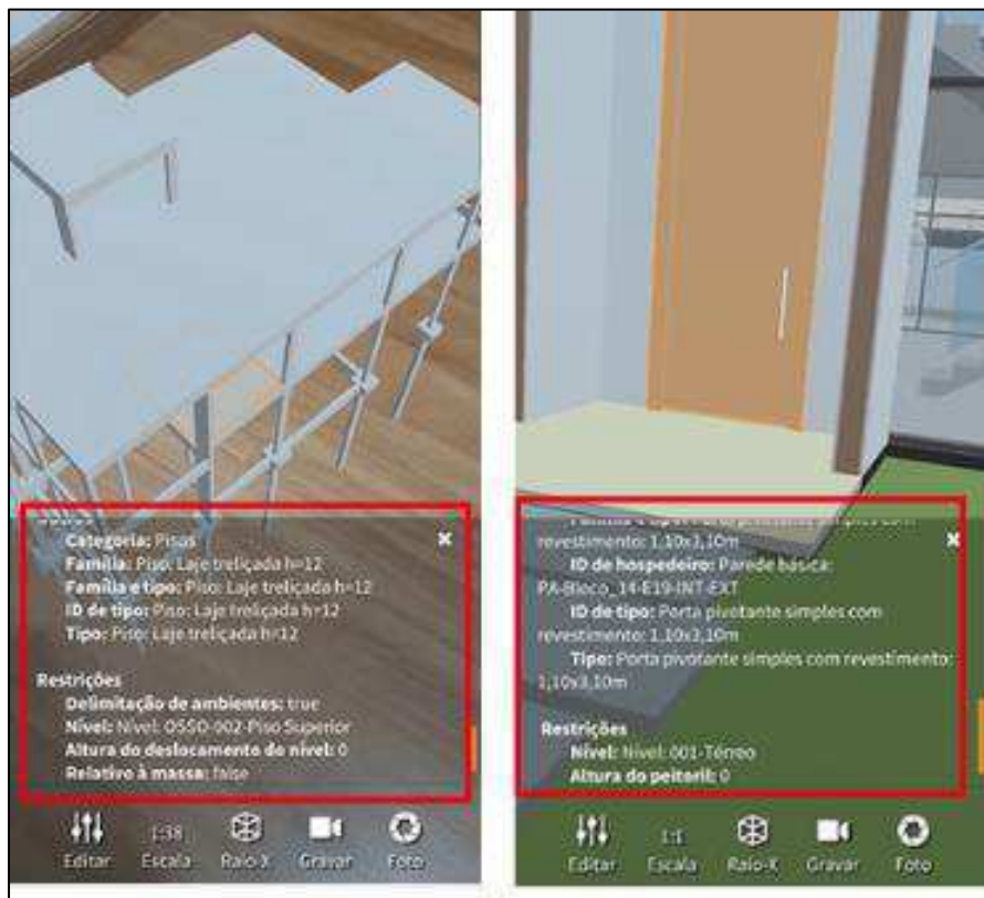
Figura 37: Informações BIM de elementos em IFC
