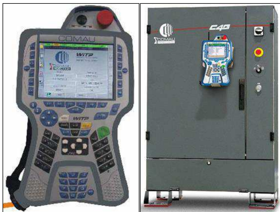
Figura 8. Terminal de programação (esquerda) e controlador (direita).
