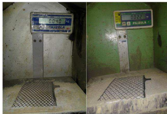
Figura 33: Verificação do peso das grades Positiva de Negativa. Fonte: Moura
