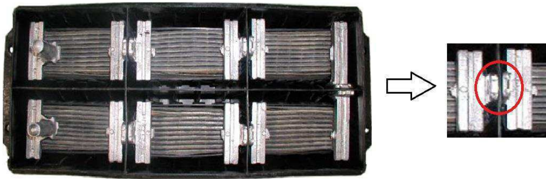
Figura 16: Solda Intercell. Fonte: PEREIRA (2006)
