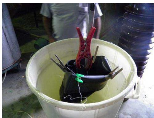
**Figura 17 – (a) Arranjo para ensaio elétrico de mangas isolantes (Fonte: COPEL, 2006); (b) Fotografia do arranjo utilizado.**
