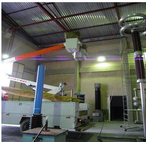
**Figura 6 – Fotografia do ensaio para verificação da corrente de fuga na lança do caminhão.**
