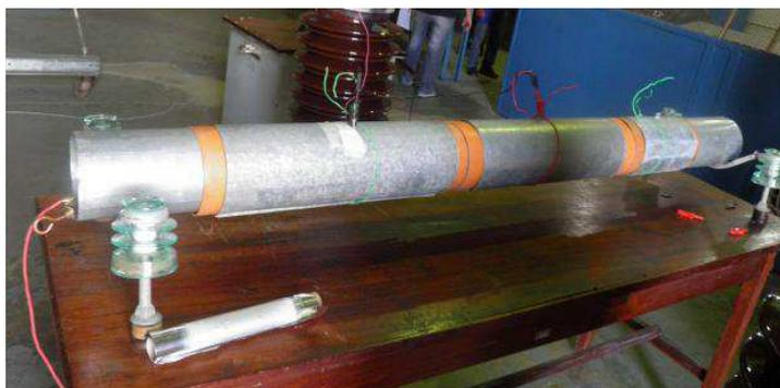
**Figura 24 – Fotografia do ensaio em coberturas protetoras circulares.**
