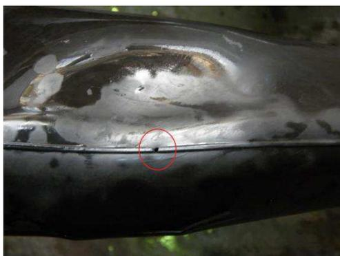
**Figura 18 – Fotografia da manga isolante reprovada no ensaio elétrico.**
