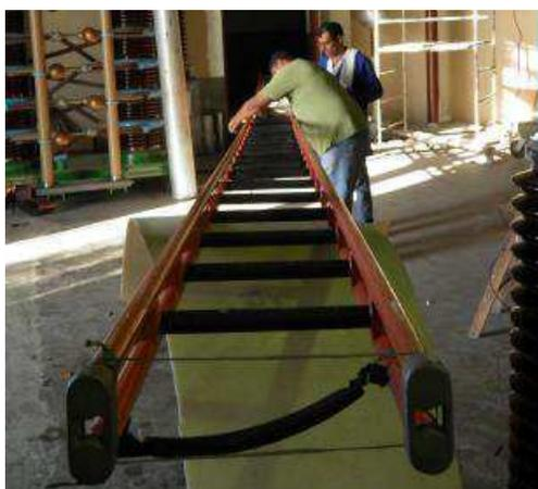
**Figura 28 – Fotografia do ensaio elétrico em escada.**
