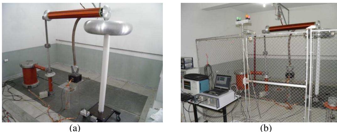
**Figura 5 – Fotografia do circuito para medição das descargas parciais: (a) Circuito elétrico; (b) Detalhe para sistema de aquisição dos dados.**
