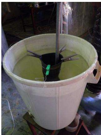
**Figura 14 – Montagem para ensaio de luvas isolantes.**
