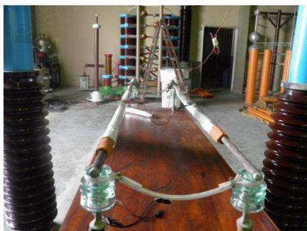
**Figura 22 – Fotografia do ensaio em coberturas flexíveis.**
