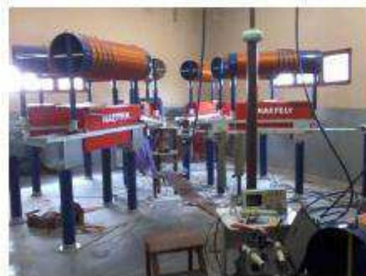
**Figura 2–Fotografia do gerador de impulso de corrente.**
