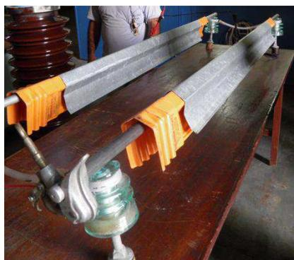
**Figura 21 – Fotografia do ensaio em coberturas rígidas.**
