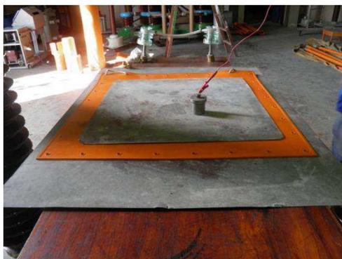
**Figura 16 – Fotografia do ensaio elétrico em lençol isolante.**
