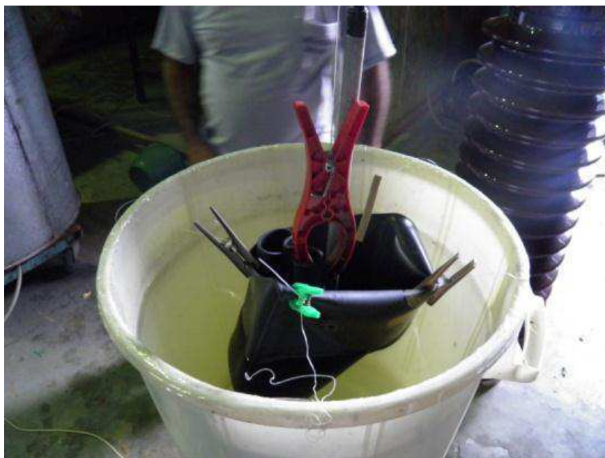
Figura 19-Fotografia do arranjo utilizado para ensaio elétrico em mangas isolantes
