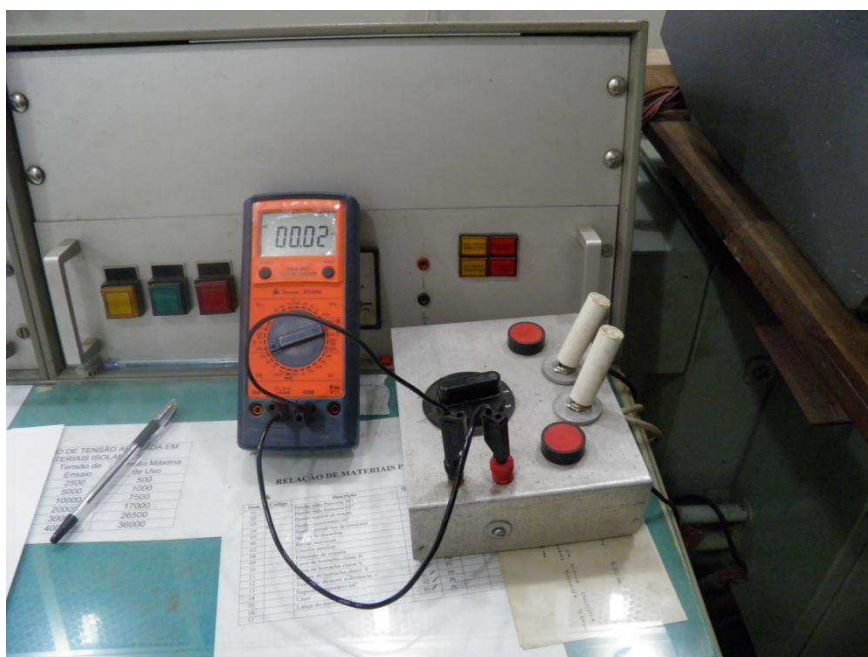
Figura 9- Fotografia do multímetro utilizado para medição da corrente de fuga
