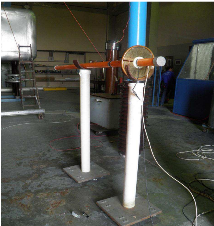
Figura 32- Fotografia do arranjo utilizado para ensaio elétrico em bastão isolante
