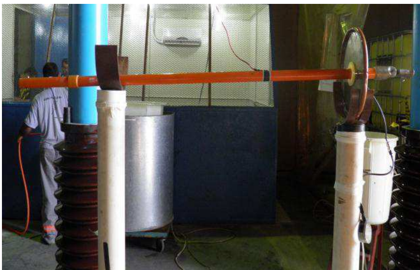
Figura 33- Fotografia do arranjo utilizado para o ensaio elétrico em vara de manobra
