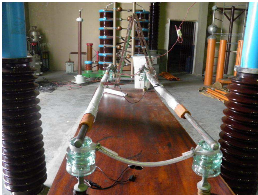
Figura 23- - Fotografia do arranjo para ensaio elétrico em cobertura flexível
