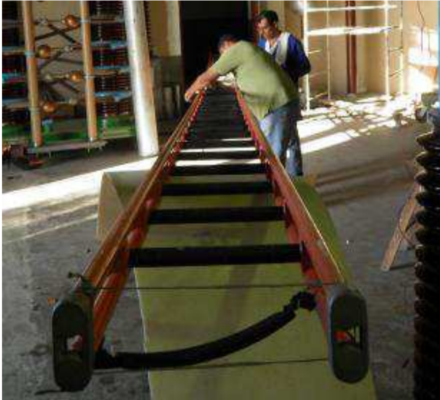
Figura 29- Fotografia do arranjo utilizado para ensaio elétrico em escada extensiva
