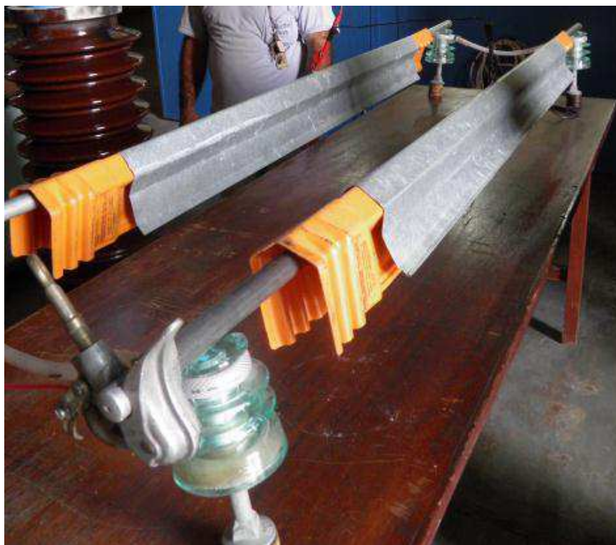
Figura 22- Fotografia do arranjo para ensaio elétrico em cobertura rígida para condutor
