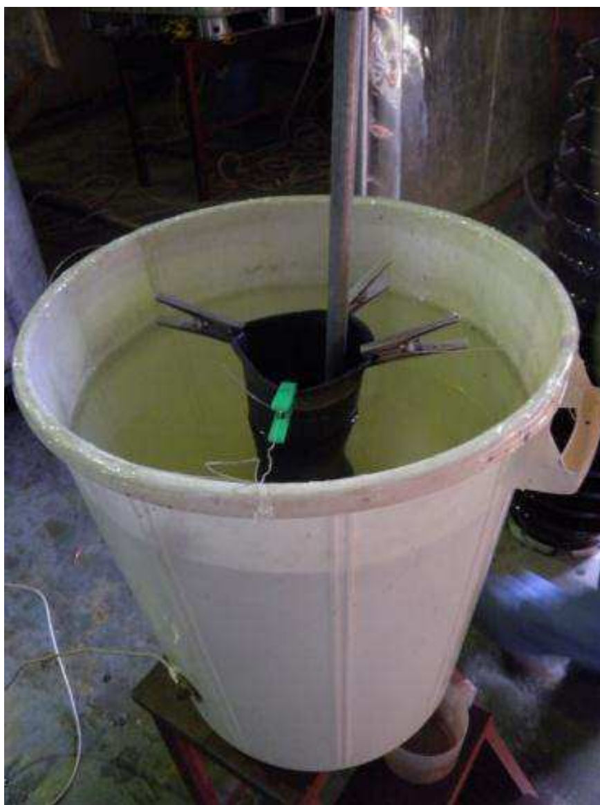
Figura 12– Fotografia do arranjo utilizado para ensaio elétrico em luvas isolantes.
