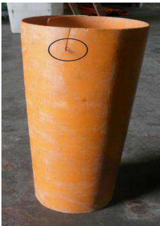
Figura 25- Fotografia da cobertura protetora circular reprovada durante a inspeção visual
