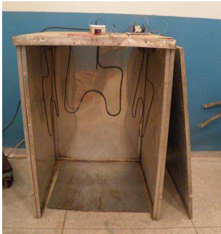
Figura 7- Fotografia da estufa utilizada para colocar o transformador
