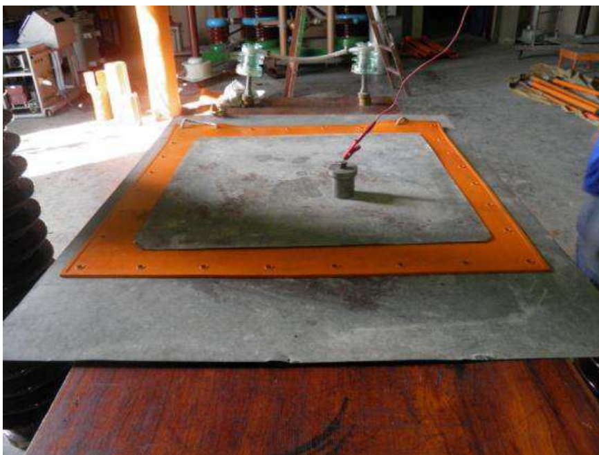
Figura 14 – Fotografia do arranjo utilizado para ensaio elétrico em lençol isolante
