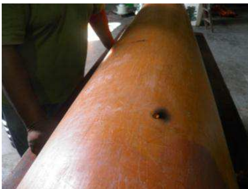
Figura 26- Fotografia da cobertura protetora circular reprovada no ensaio devido à ocorrência de perfuração
