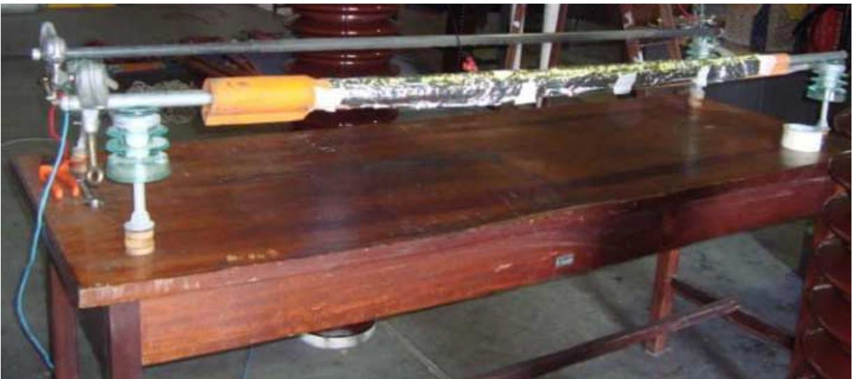
Figura 10. Fotografia de ensaio de proteção para condutores tipo flexível.
