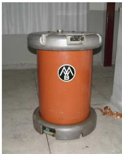
Figura 16. Fotografia do transformador para ensaios.
