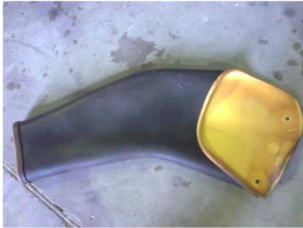
Figura 7. Manga isolante ensaiada do fabricante salisbury
