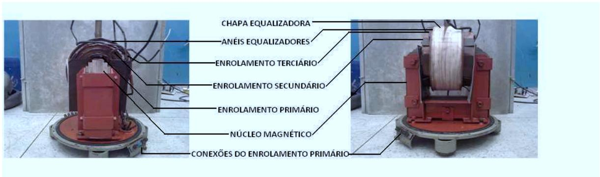
Figura 17. Fotografia da parte ativa do transformador. Vistas lateral e frontal.
