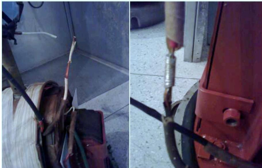
Figura 20. Fio partido durante a manutenção e emenda reforçada
