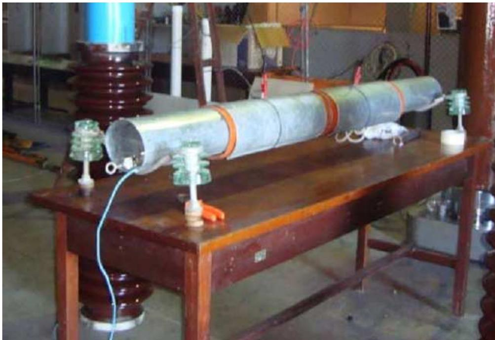
Figura 11. Fotografia de ensaio de cobertura protetora circular para postes.
