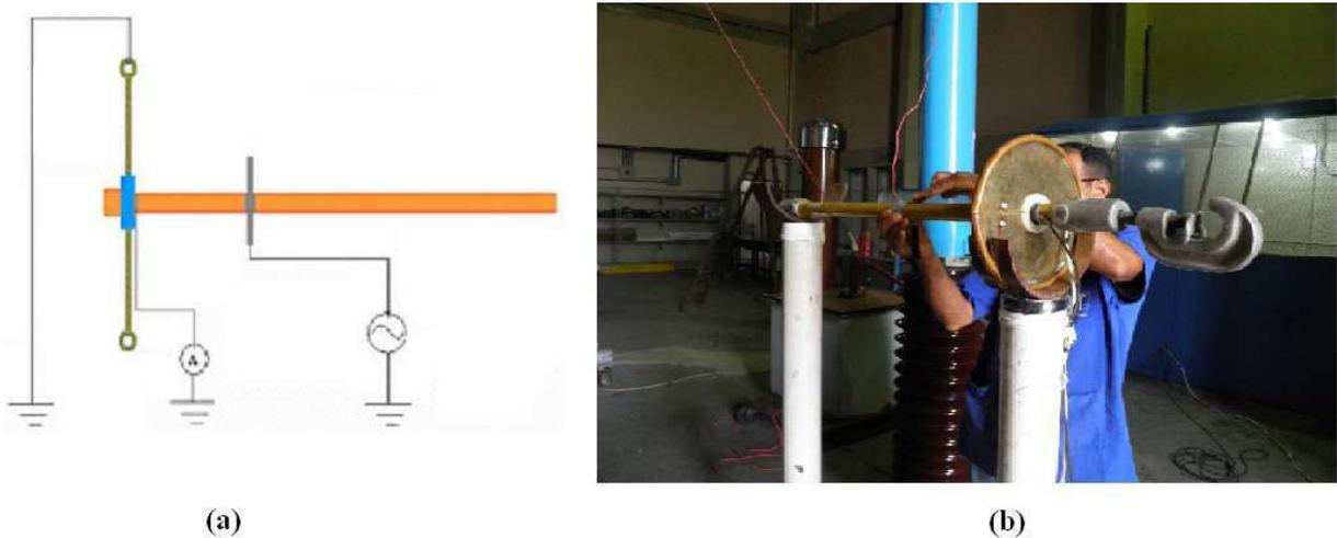
Figura 13. Ensaio de vara de manobra. (a) Esquema de ensaio. (b) Fotografia do esquema de ensaio. Fonte:
