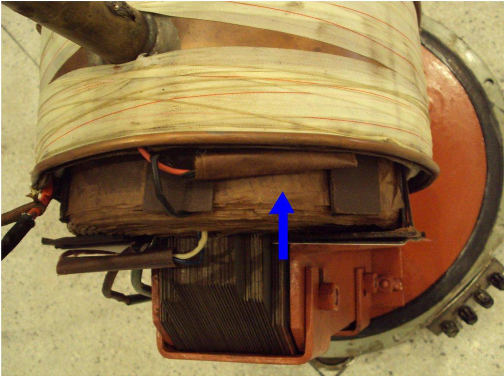
Figura 19. Detalhe da localização do defeito no transformador.
