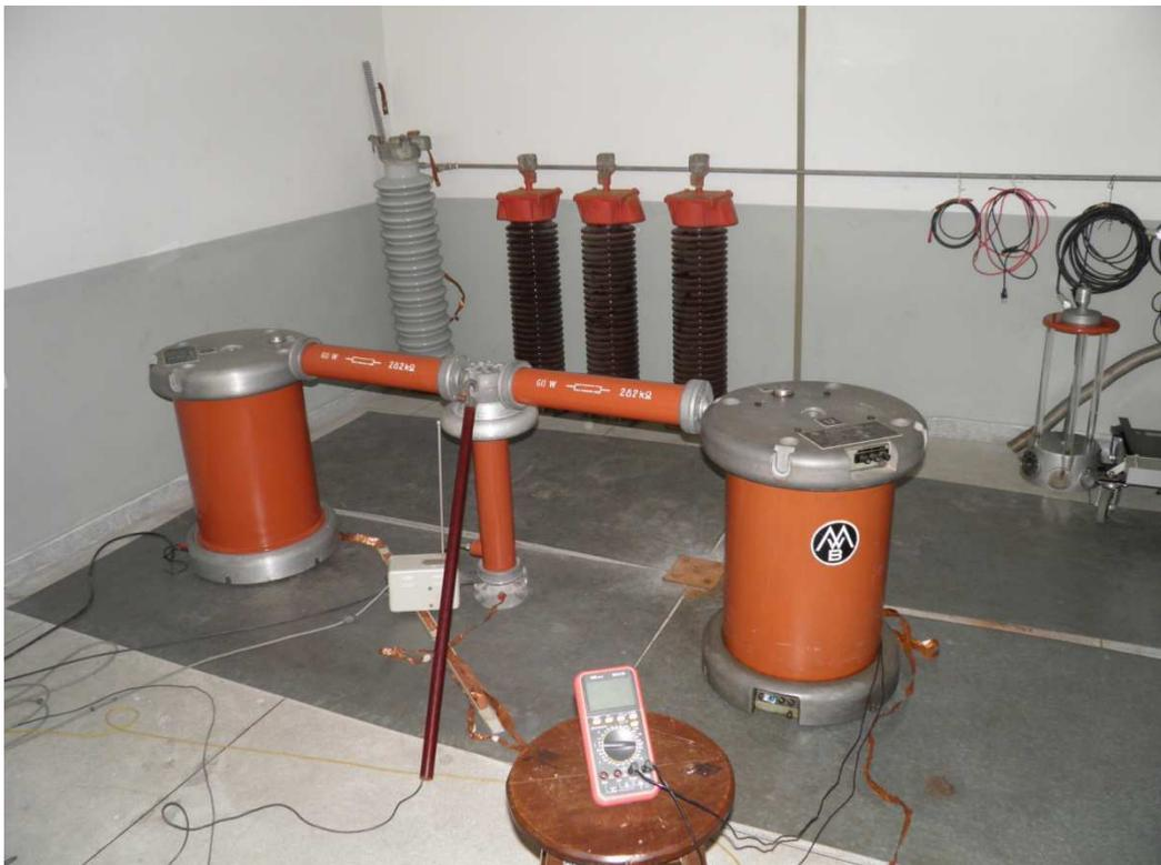
Figura 21. Fotografia do circuito para medição de relação de tensão do transformador.
