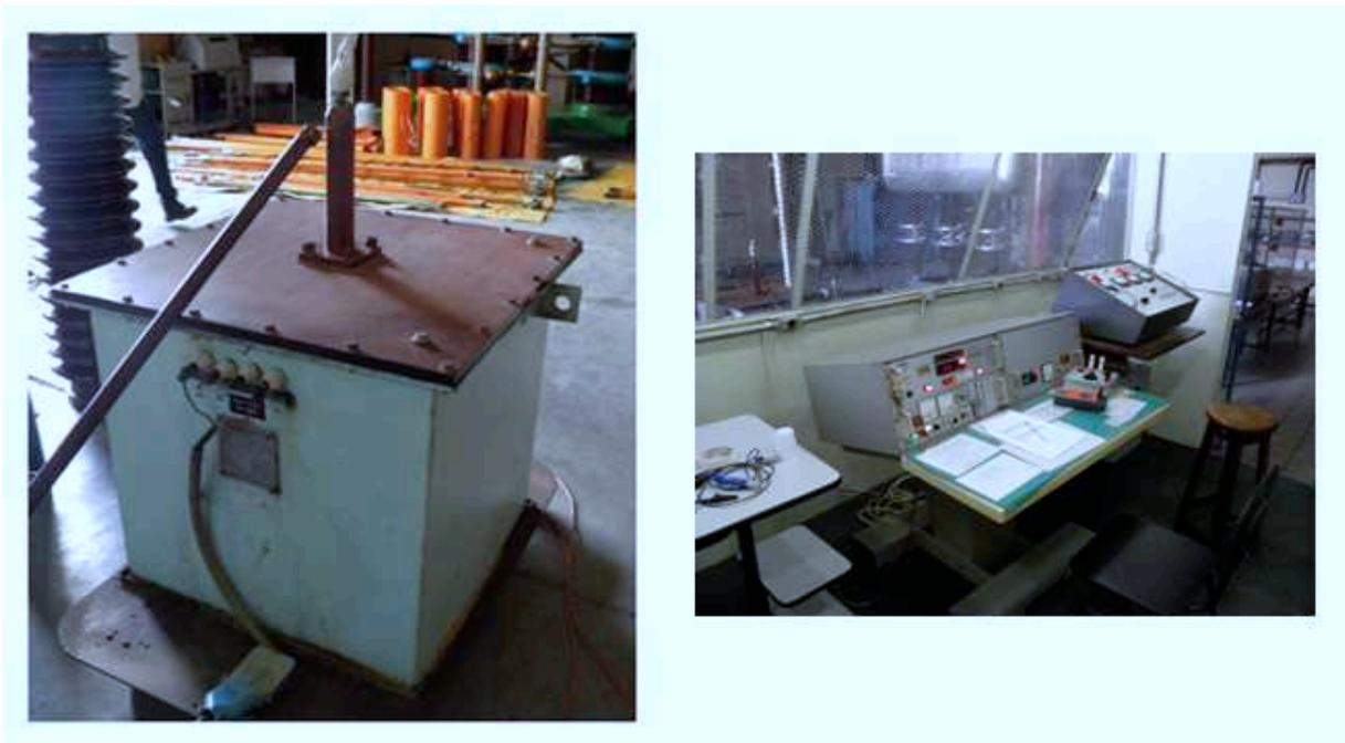
Figura 3. Transformador para ensaios utilizado no LAT e sua mesa de controle.
