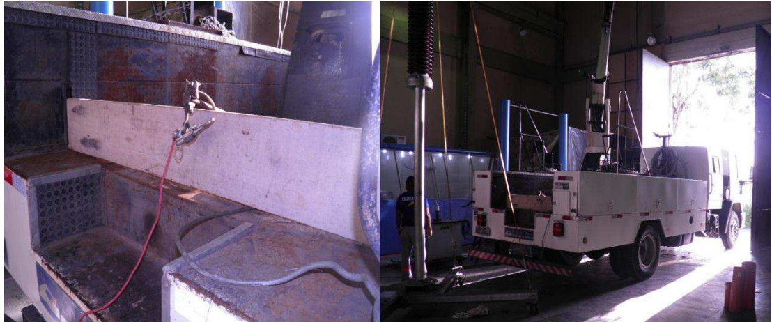
Figura 17 - Detalhes do ensaio da lança isolante (na carcaça metálica é realizado o aterramento).
