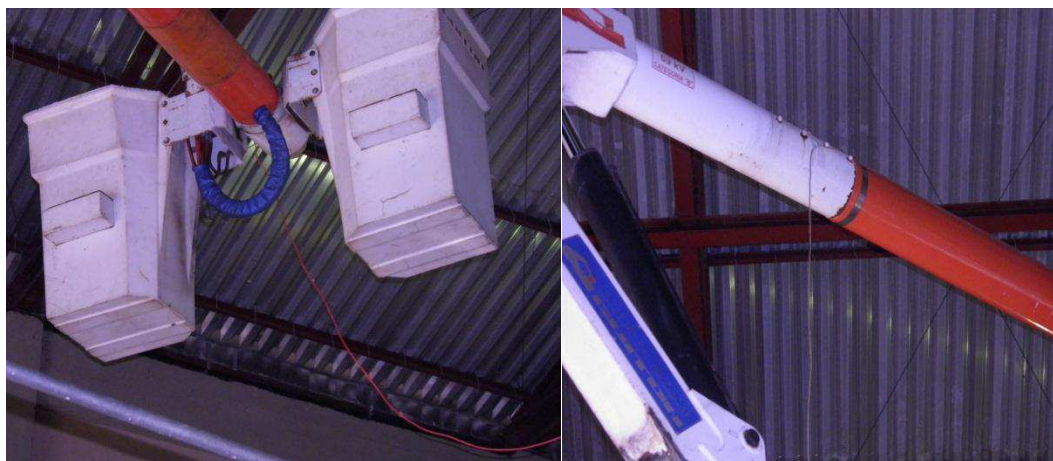
Figura 16 - Detalhes do ensaio da lança isolante (parte final da lança).
