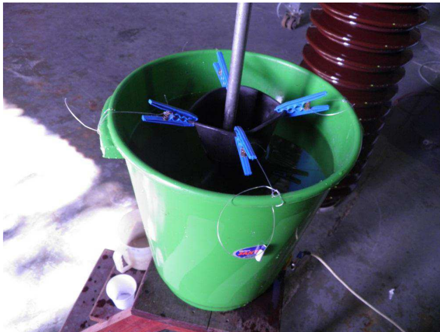
Figura 9 - Fotografia do ensaio em luva isolante.
