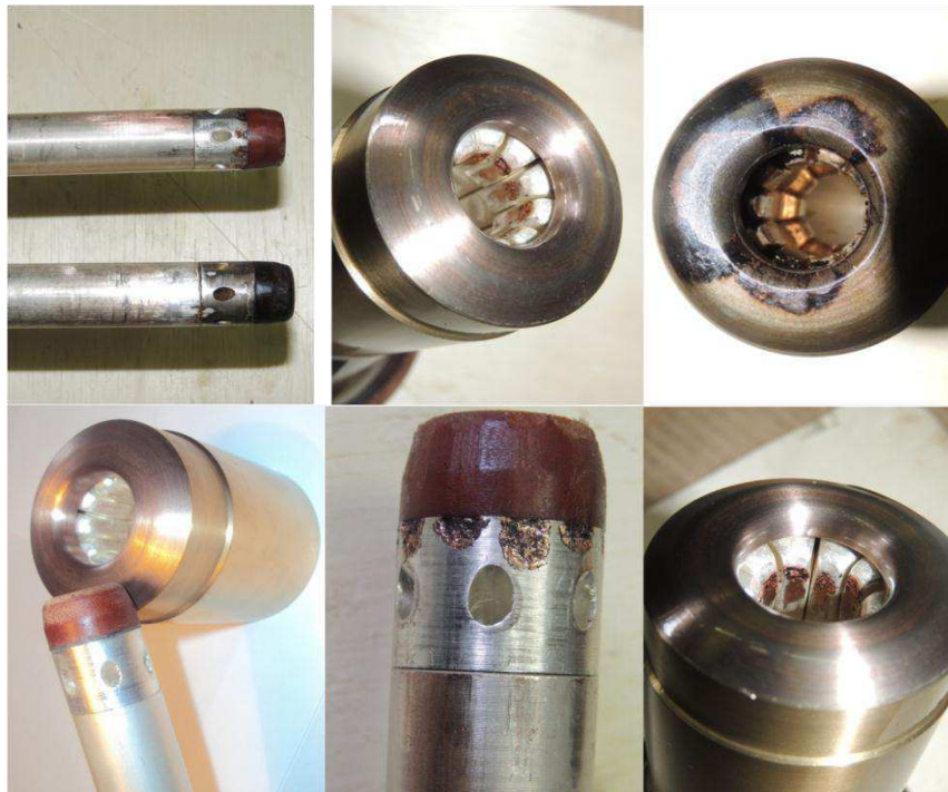
Figura 24 - Estado dos contatos após ensaios de degradação dos contatos.
