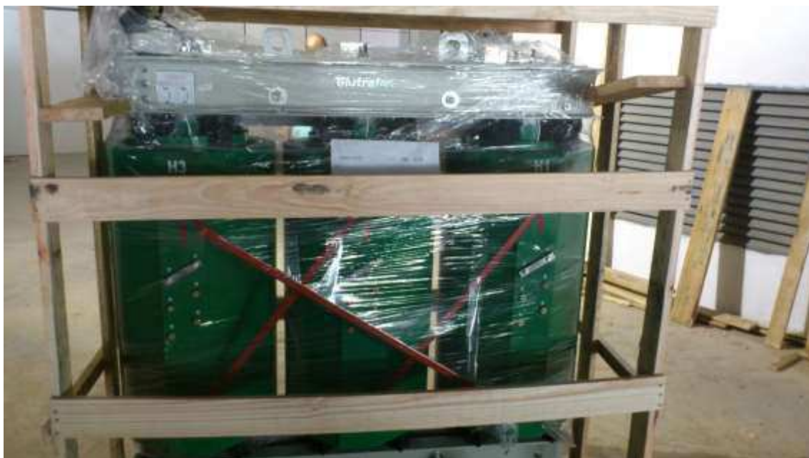
Figura 12: Transformador 13,8 kV/ 380V delta estrela a seco.
