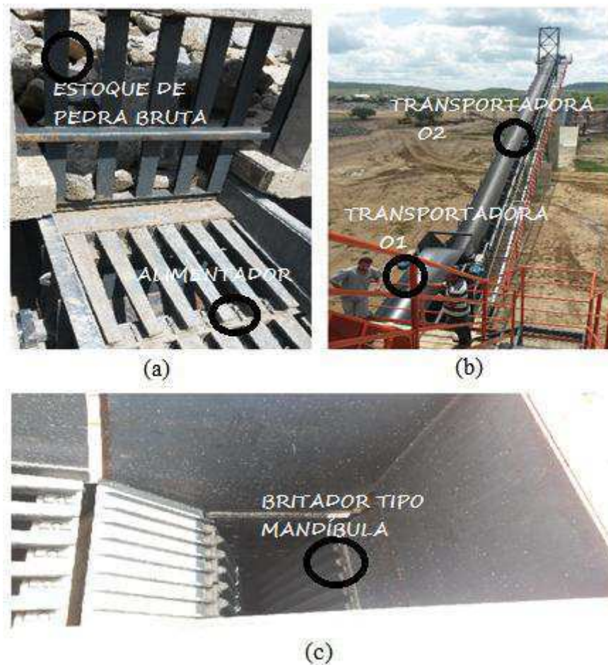
Figura 11: Imagens da linha de britagem primária.
