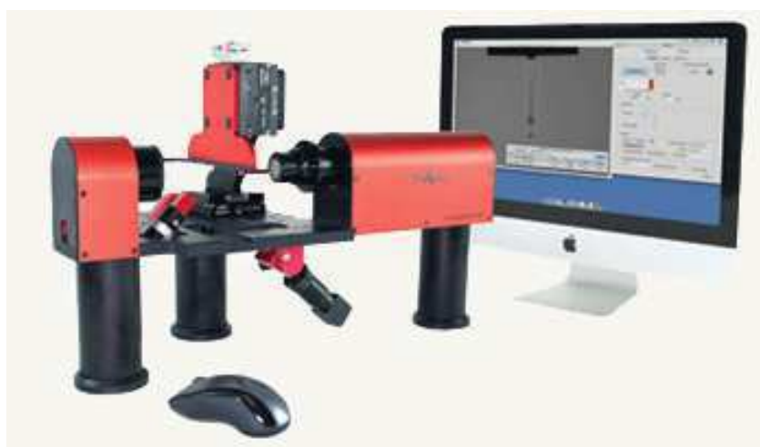
Figura 16 – O Sistema de visão JetXpert para análise de cabeças de impressão CIJ. Fonte: ( JETXPert, 2014 ).
