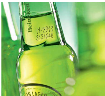
Figura 9 – Impressão a jato de tinta com o modelo 9232 da Markem-Imaje. Fonte: (MARKEM-IMAJE, 2014).
