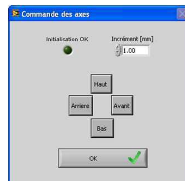
Figura 32 – Janela da GUI para controle dos eixos motorizados.
