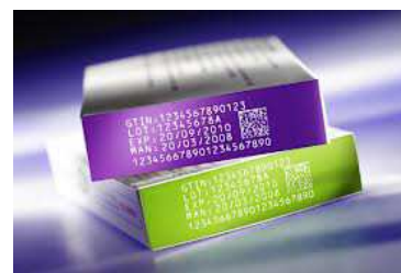
Figura 10 – Impressão a laser com o modelo 7031 HD da Markem-Imaje. Fonte: (MARKEM-IMAJE, 2014).
