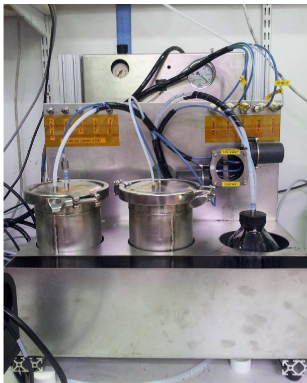
Figura 33 – Foto do circuito de tinta externo produzido por Markem-Imaje.
