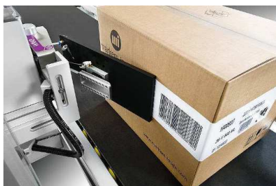
Figura 8 – Codificação de caixas de papelão com a série 2200 da Markem-Imaje. Fonte: (MARKEM-IMAJE, 2014).
