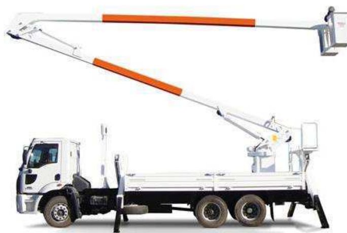
Figura 19. Caminhão equipado com Cesta Aérea e Lança Isolante.
