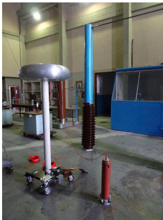
Figura 17. Objeto teste ligado ao SC5B (situado em cima do capacitor padrão) e visão do capacitor padrão.
