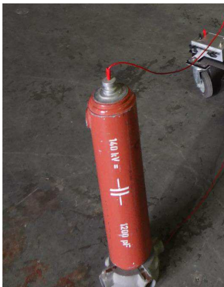
Figura 14. Objeto teste (capacitor de 1200 pF).
