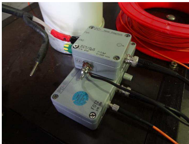
Figura 16. Conexão entre o SC1/0 \mu 5, o capacitor padrão e o FOT N.
