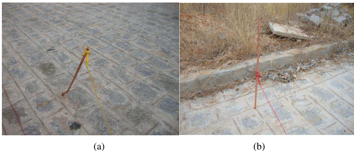
Figura 85 – Detalhe das pontas de prova, distanciadas para aplicação do Método de Wenner.
