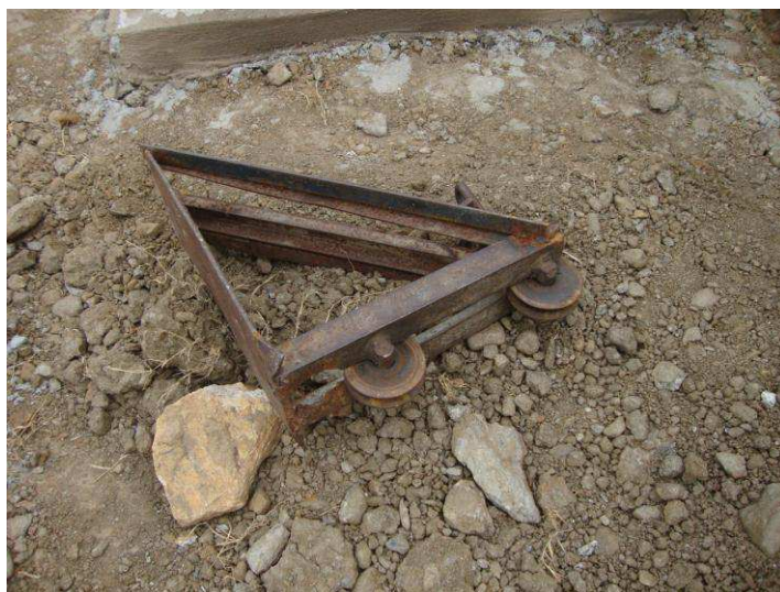
Figura 56 – Base de polias (talha) a ser posicionada no poste.
