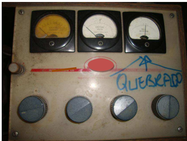
Figura 2 – Painel do TTR, contendo chaves seletoras e medidores.
