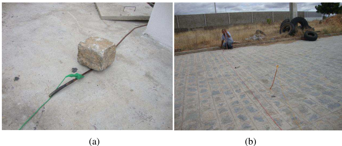
Figura 84 – Conexão das pontas de prova às hastes de aterramento.
