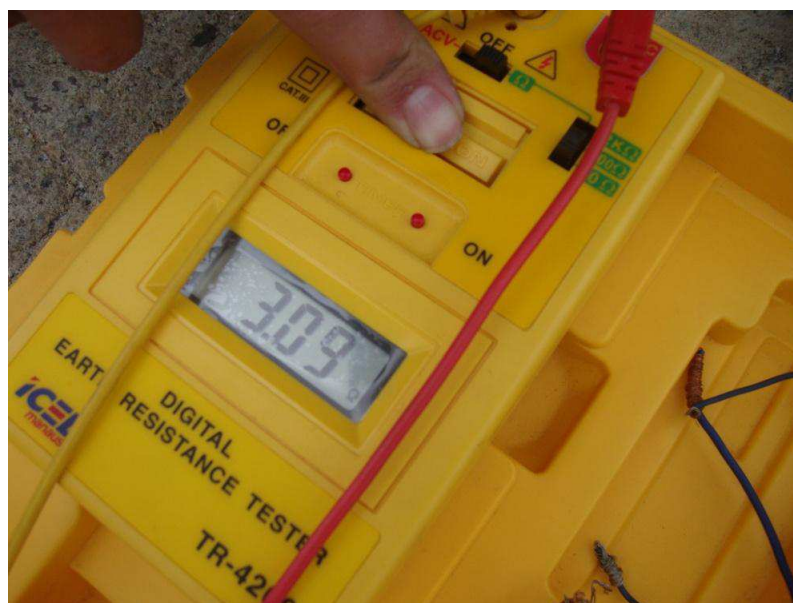
Figura 86 – Resistência de terra aferida pelo aparelho.
