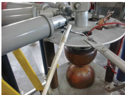
Figura 4.22 – Vara de aterramento em posição estável e em contato contínuo com o nó central do GIC.
