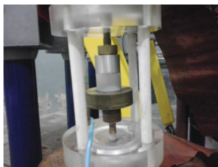
Figura 4.7 – Objeto de teste: cilindro de alumínio em série com um bloco varistor de mesmo formato e dimensão.
