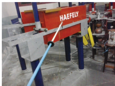
(a) Tocando com a vara nas partes metálicas mais próximas ao usuário.
