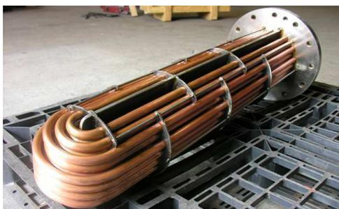
(a) Tubulação de um trocador de calor do tipo casco e tubo. Fonte: [?]
