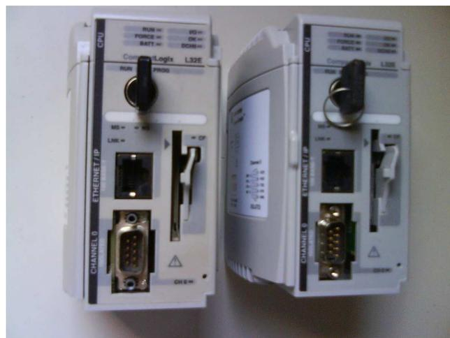
Figura 21 – CLP utilizado na implementação do sistema de controle.
