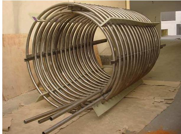
(a) Esquemático de um trocador de calor serpentina.
