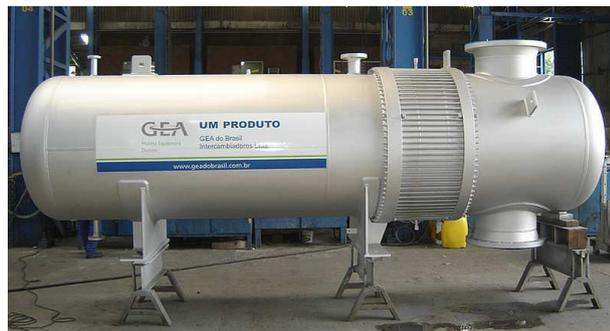
(b) Trocador do tipo casco e tubo industrial. Fonte: [?]
