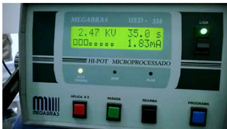
Figura 4.13 – Medição da corrente de fuga com um Hi-pot.
