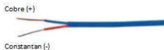
Figura 22. Extremidade desencapada de termopar tipo T.
