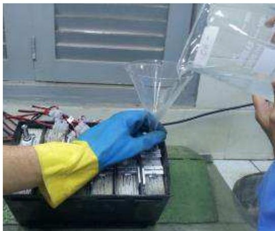
Figura 25. Enchimento por gravidade realizado nas amostras Am. 01 e Am. 02.
