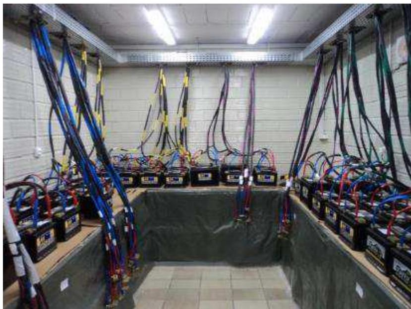
Figura 12. Bancadas de ensaio com amostras conectadas.
