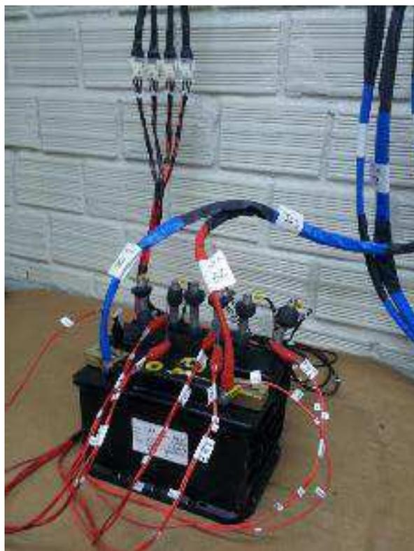
Figura 6. Bateria M60GD instrumentada para ensaio RC com cádmio.
