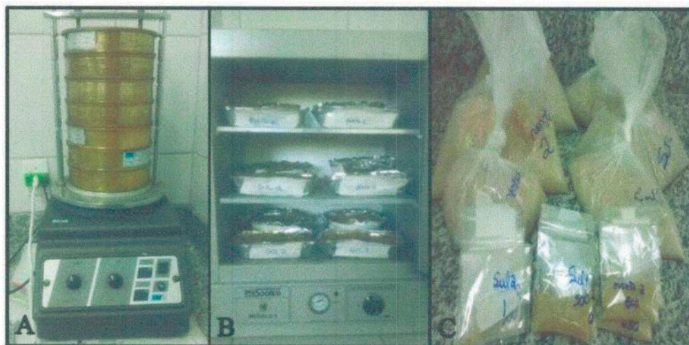
Figura 7 Amostra de sedimento para a granulometria (A= Máquina Rot-up; B= Sedimento acondicionado estufa; C= Sedimentos peneirados).
