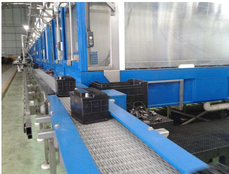
Figura 17: Baterias na esteira para conexão nos bancos de formação.
