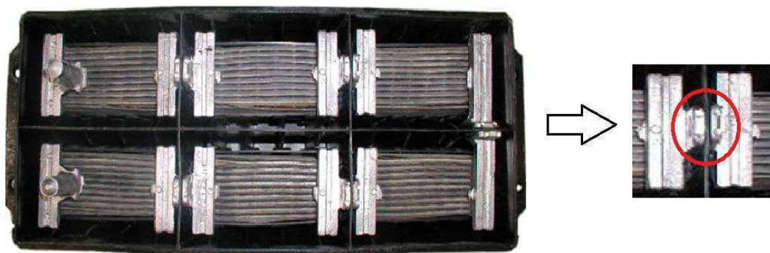
Figura 11: Solda Intercell. Fonte: Alves e Pereira (2006)
