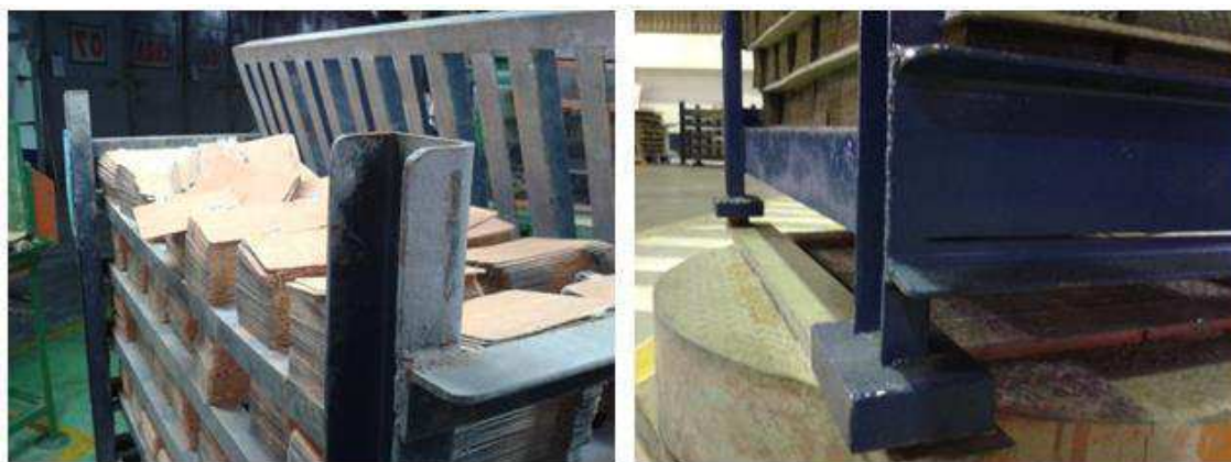
(a) (b) Figura 27: (a) Viga do cavalete de placas. (b) Base inferior do cavalete.
