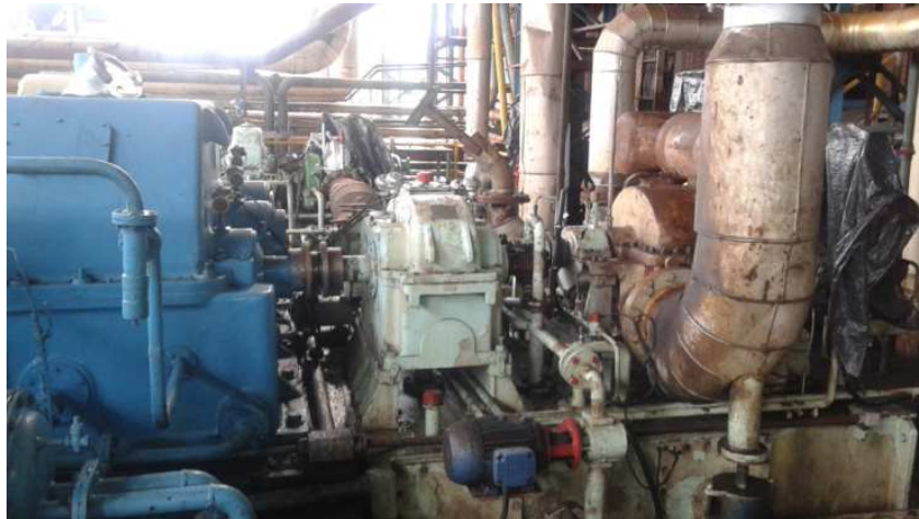
Figura 32 - Turbina do primeiro acionamento da moenda.
