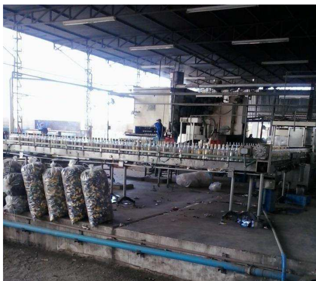
Figura 8 – Retirada de conta-gotas e entrada na máquina de tirar rótulo.
