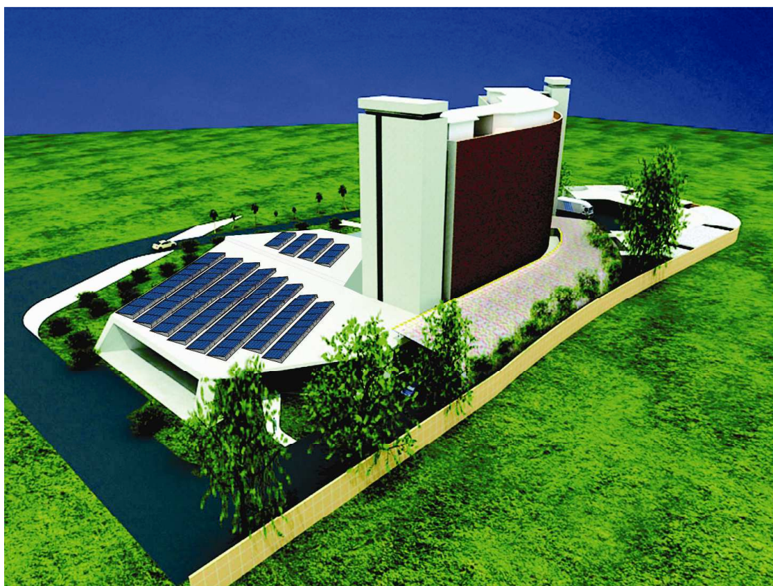
Figura 9.2. Montagem do prédio da Fiep mostrando a disposição dos painéis na laje.
