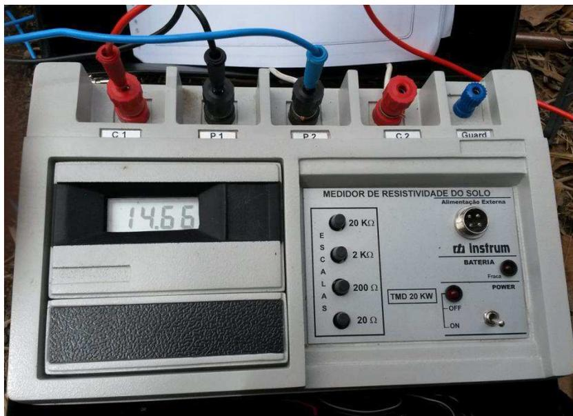
Figura 8. Fotografia do terrômetro em funcionamento.
