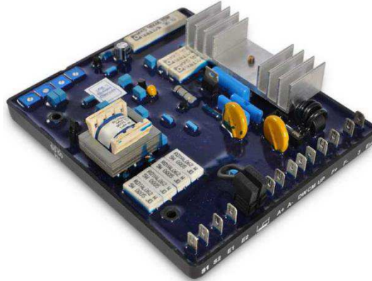
Fig. 13. Regulador de tensão automático.
