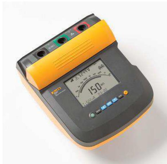
Figura 21: megômetro utilizado no comissionamento de motores.
