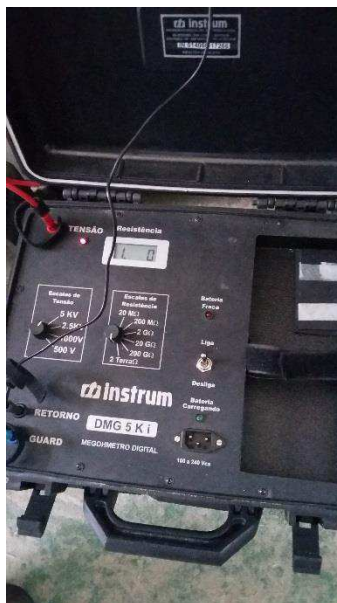
FIGURA 23: MEDIÇÃO DA RESISTENCIA DE ISOLAMENTO
