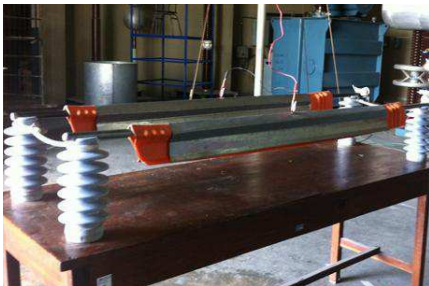
Figura 3: Ensaio de coberturas isolantes.
