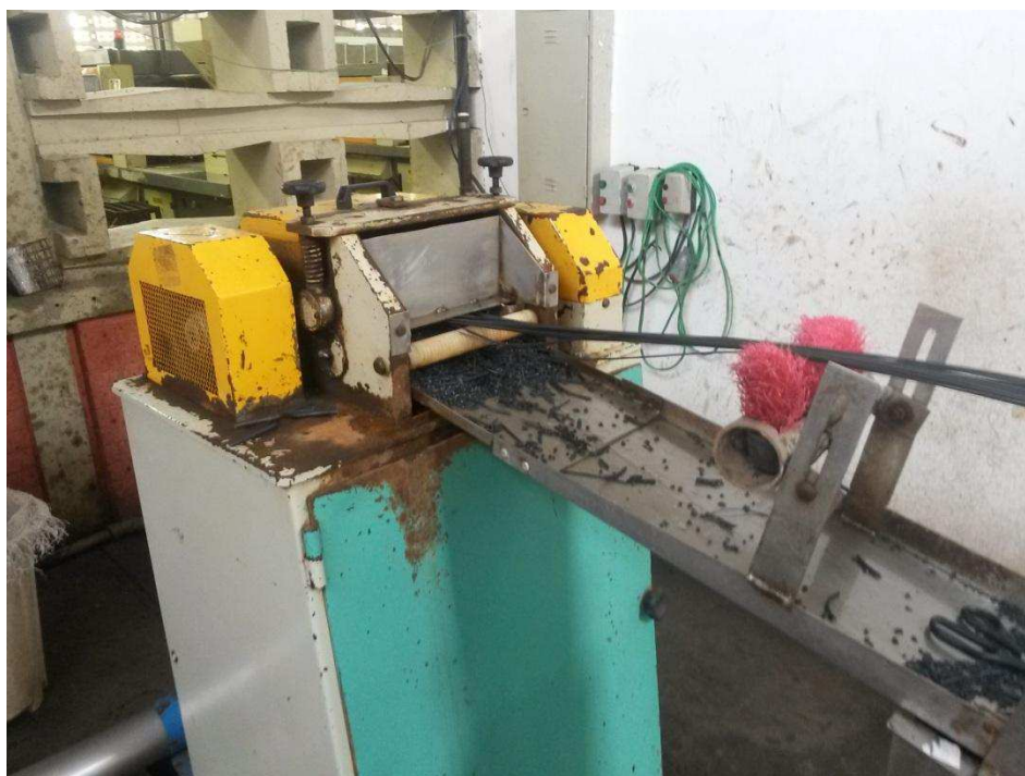
Figura 10 – Fotografia da entrada do material contínuo no picotador.
