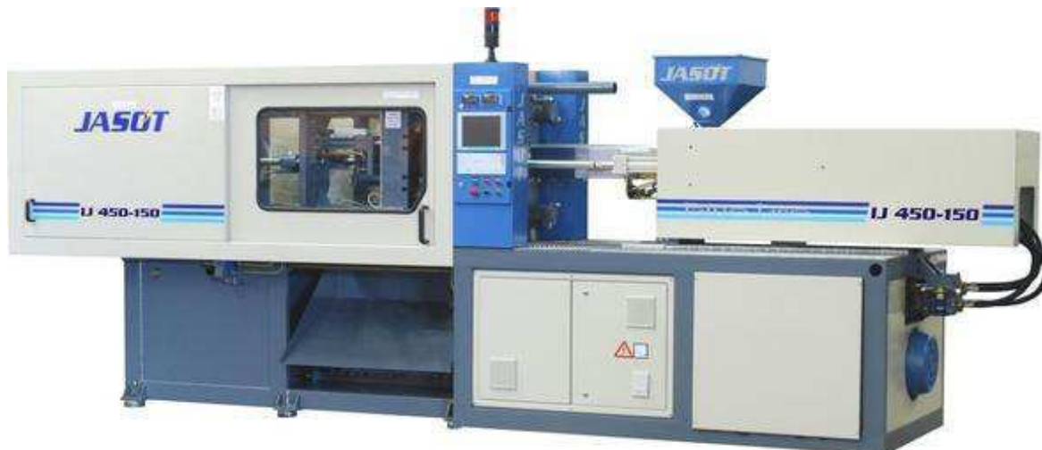
Figura 11 - Injetora horizontal da marca JASOT, utilizada na Duraplast. Fonte: www.logismarket.ind.br
