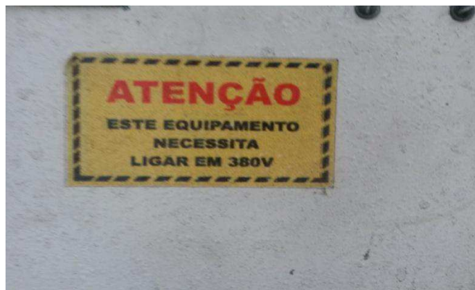
Figura 18 – Foto da sinalização nas injetoras informando a tensão de ligação.
