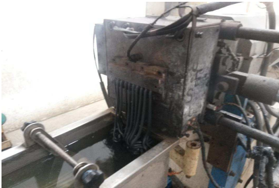
Figura 9 – Fotografia do material na saída do cabeçote da extrusora em direção a banheira de resfriamento.
