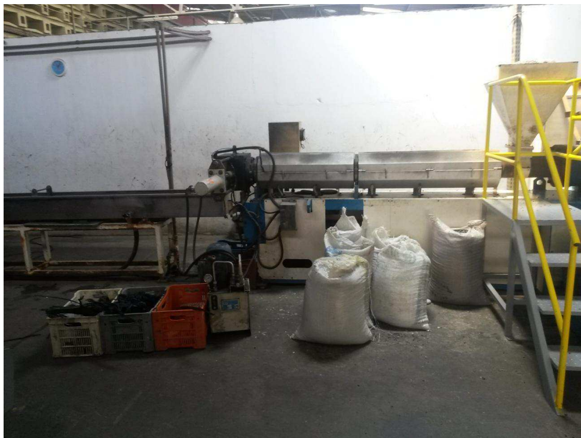
Figura 8 – Fotografia da extrusora mais a banheira de resfriamento.
