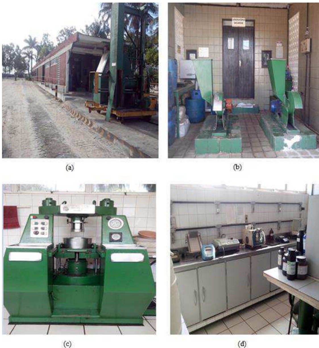
Figura 2 - (a) Visão da balança rodoviária, laboratório industrial e sonda. (b) Forrageira. (c) Prensa industrial. (d) Laboratório onde é feito o controle de qualidade.
