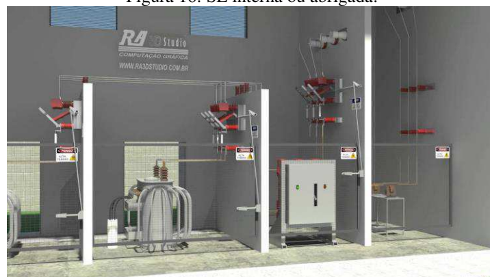
Figura 16: SE interna ou abrigada.
