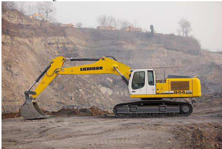
Figura 13: Escavadeira hidráulica R944C.
