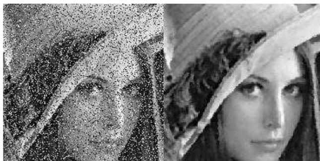
Figura 3. Aplicação do filtro da mediana para remoção de ruído.
