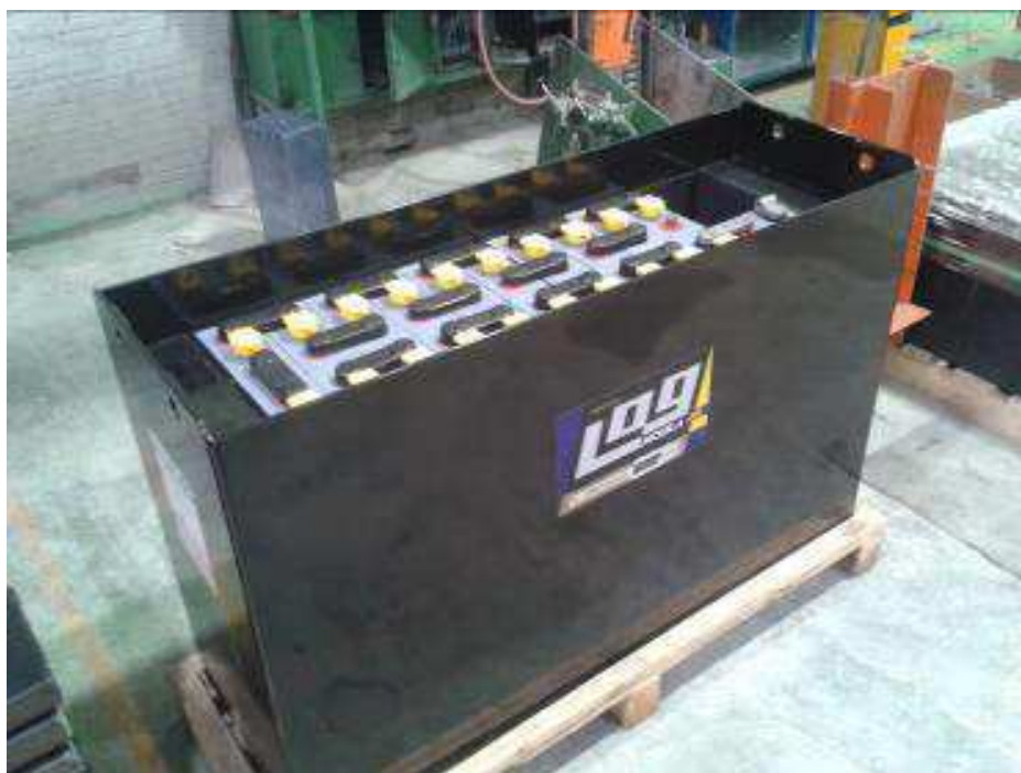
Figura 10 - Montagem de Bateria Tracionaria.
