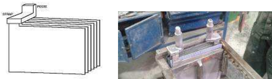
Figura 5 - Solda HDP (Orelha Lateral) Fonte: DINIZ, 1994.
