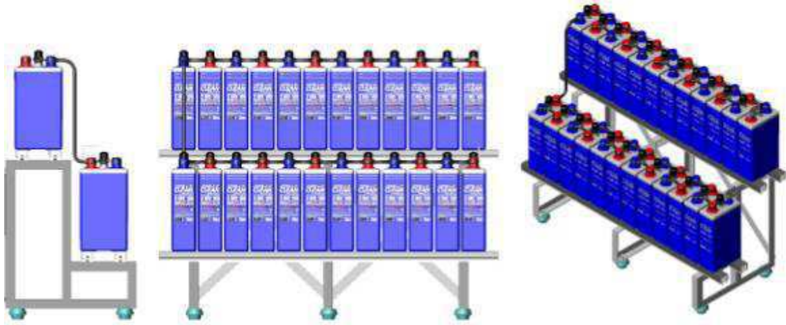
Figura 11- Exemplo de montagem da bateria em estante Fonte: ACUMULADORES MOURA,2014.
