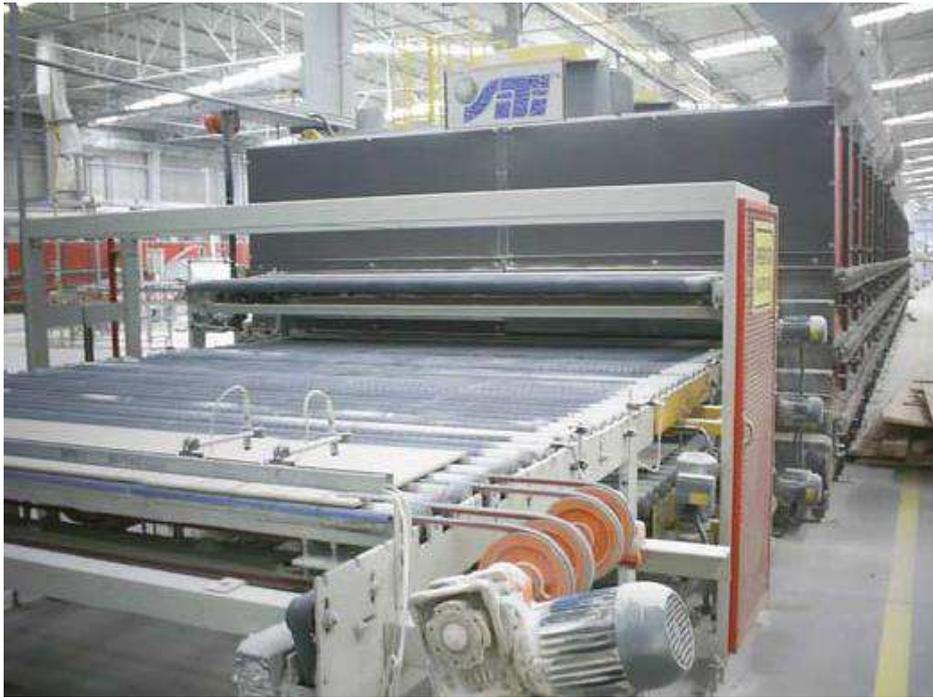
Figura 8 – Secador horizontal.
