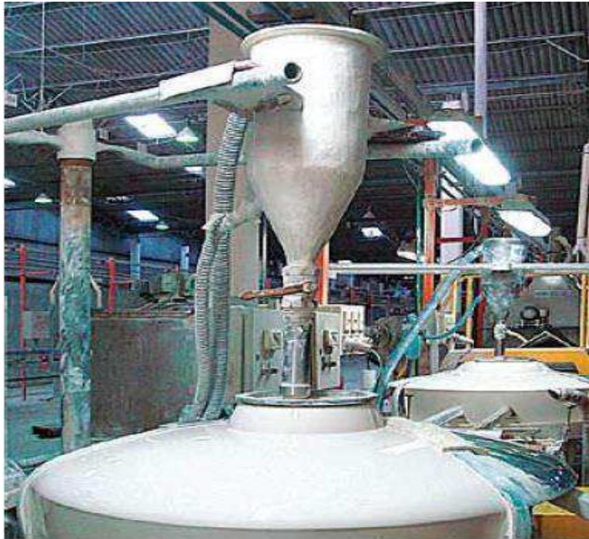
Figura 9 – Aplicação da camada de esmalte.
