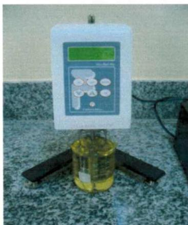
**Figura 6.** Viscosímetro rotacional de bancada (VISCO BASIC Plus, FUNGILAB)
